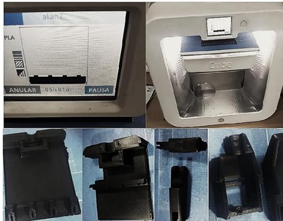
**Figura 120.** Impresión de piezas mediante CUBE
