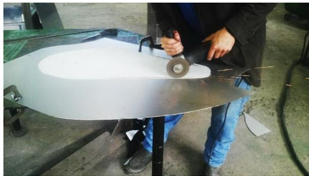
**Figura 48 Corte de las Caras Laterales mediante una Moladora**
