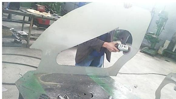
**Figura 49 Limado y pulido de los cortes para soldadura TIG**
