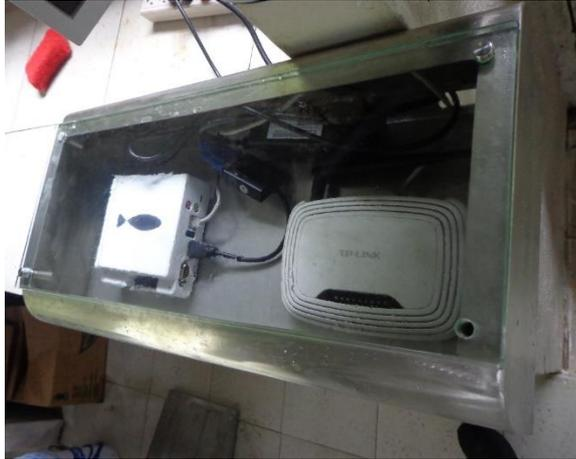
**Figura 68 Carcasa terminada para contener dispositivos electrónicos.**
