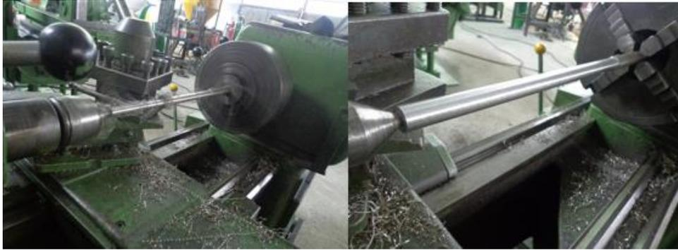
**Figura 55 Maquinado del eje.**
