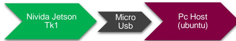
**Figura 71 Diagrama de conexión para flasheo.**
