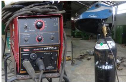
**Figura 50 Equipo de Soldadura TIG.**
