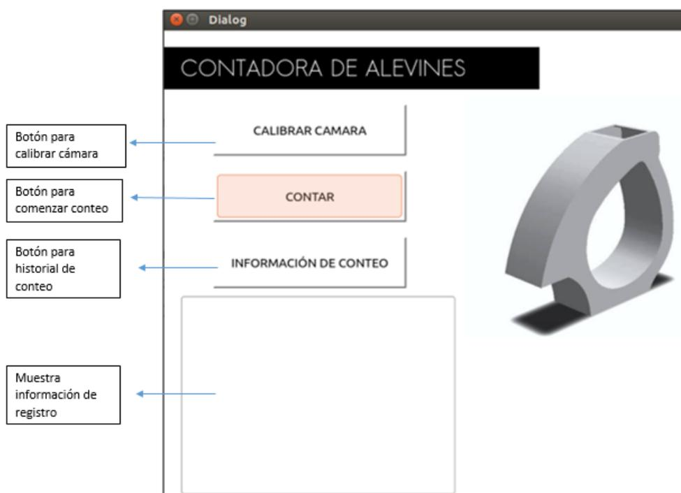
**Figura 102 Partes del HMI.**
