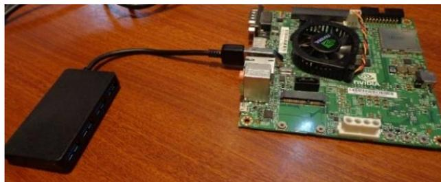
**Figura 74 Conexión de extensor Usb 3.0**
