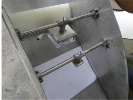
**Figura 60 Montaje de los soportes en la máquina.**
