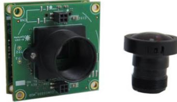
**Figura 38 Cámara See3CAM\_CU30 y lente M12.**
