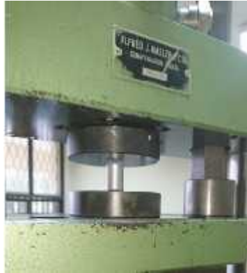
Figura 106. Máquina de ensayos universales – Ensayo de Compresión
