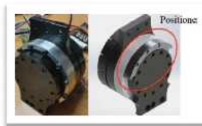
Figura 23. Motor BLDC, Harmonic Drive (reductor), módulo de encoder y posicionador de KUEX-R.
