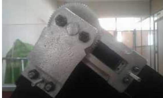
Figura 116. Ensamble mecánico final de la articulación general de rodilla
