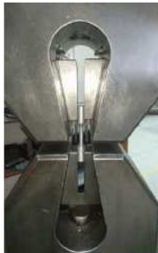
Figura 105. Máquina de ensayos universales – Ensayo de Tracción
