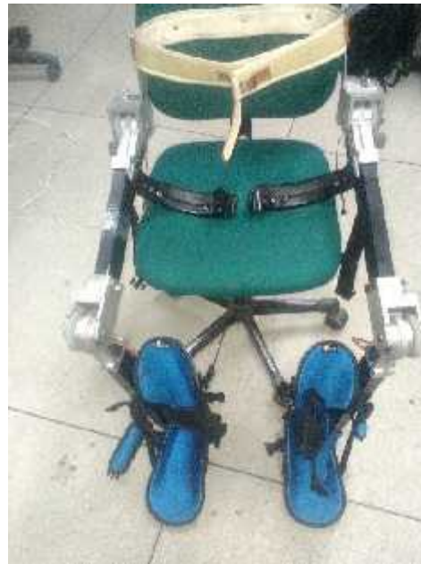
Figura 127: Actuadores rotacionales ubicados en las articulaciones
