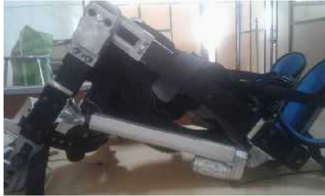
Figura 118. Ensamble final de las piernas del prototipo de exoesqueleto con actuador lineal colocado como musculo biarticulado
