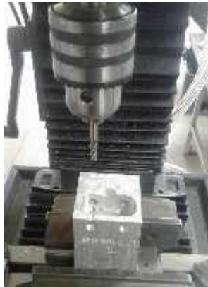
Figura 114. Fresado y desbaste del material en exceso
