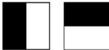
**Figura 20. Filtros de Haar para la respuesta en  $x$ ,  $y$ . La parte negra tiene peso  $-1$  y la blanca  $+1$ .**
