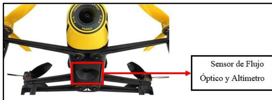
**Figura 41. Localización del sensor de flujo óptico para estimación de la velocidad del drone.**
