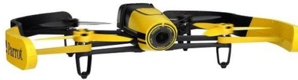
**Figura 27. Bebop 1 de Parrot con las protecciones de espacio interior EPP**
