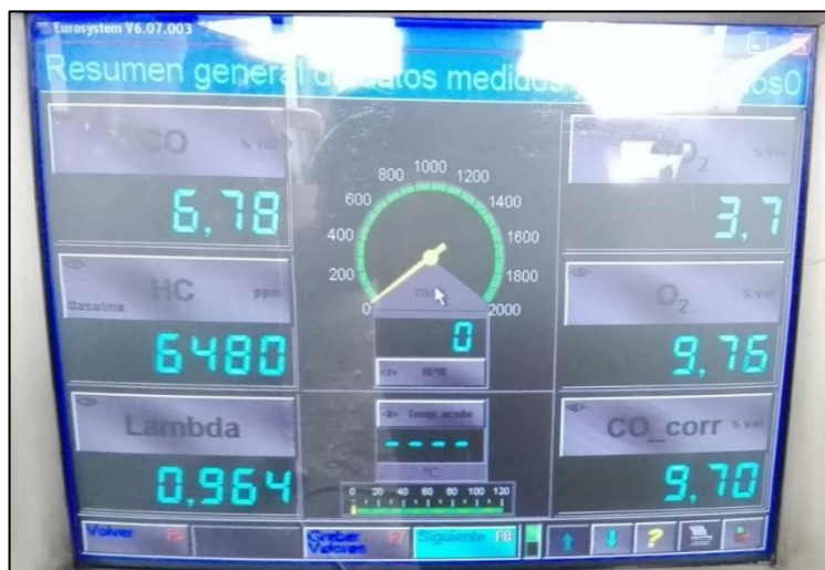
Figura 41. Prueba de gases contaminantes en ralentí
