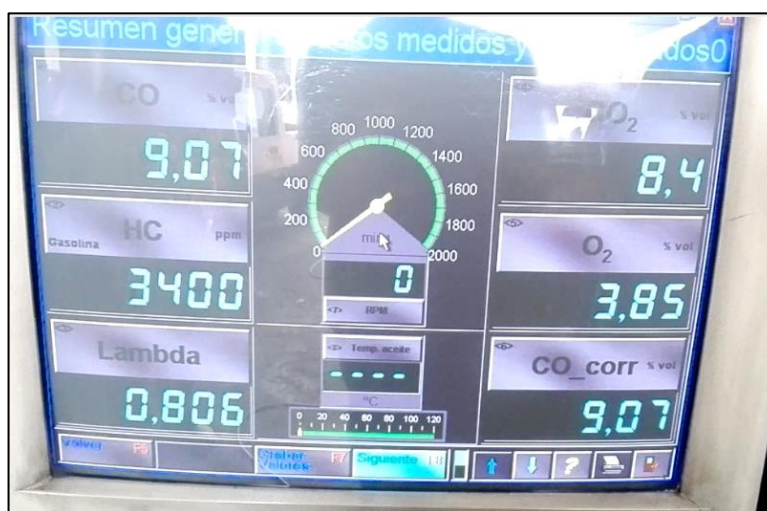
Figura 42. Prueba de gases contaminantes en altas revoluciones, 2500 rpm
