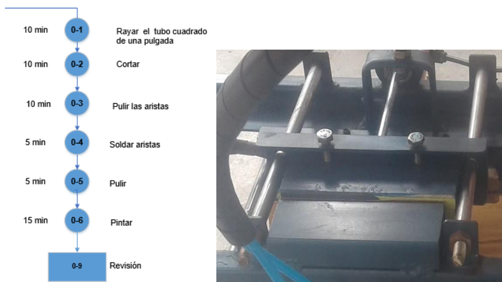
Figura 41: a) diagrama de construcción b) base selladora horizontal.
