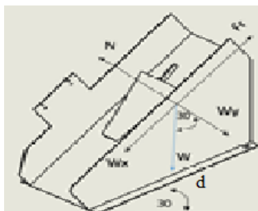
Figura 18 Diagrama de cuerpo libre de un helado sobre la resbaladilla.
