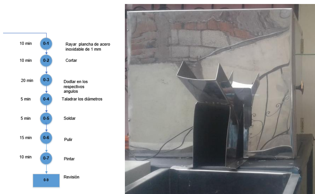
Figura 44 a) diagrama de construcción b) resbaladilla
