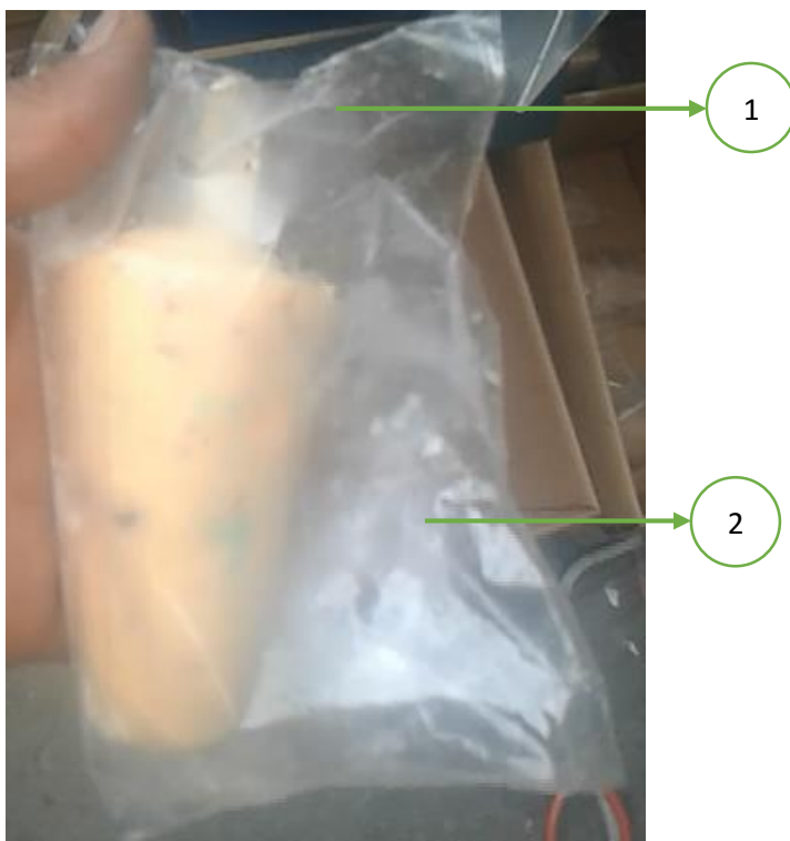
Figura 65 Sellado (1) vertical, (2) horizontal
