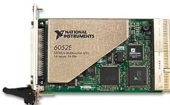
**Figura 21 DAQ NI PXI-6052E**
