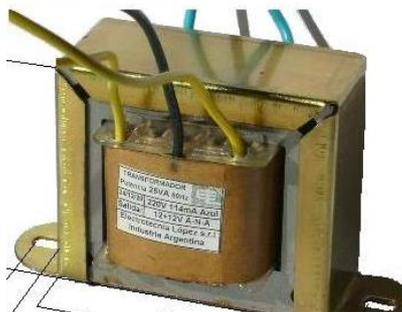
**Figura 17** Transformador de potencial
