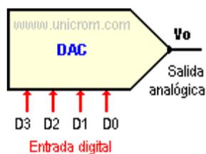
**Figura 18 Resolución de un dispositivo DAC**
