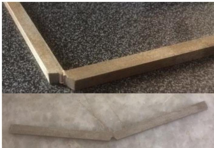
**Figura 84** Probetas después del ensayo Charpy fallido.
