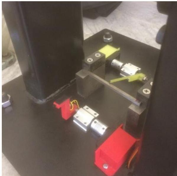
**Figura 83** Ensayo Charpy instrumentado-Probeta acero SAE 1040(5x5)
