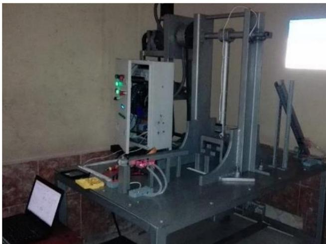
**Figura 58** Equipo de fuerza de impacto, con sistema de elevación, frenado y HMI.
