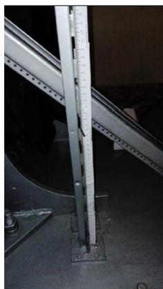
**Figura 59** Posicionamiento de la altura de la rampa.
