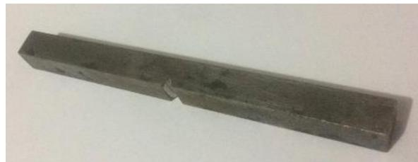
**Figura 20** Forma y posición de la probeta para ensayo Charpy.
