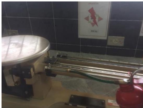
**Figura 69** Aceitado y enceramiento balanza.
