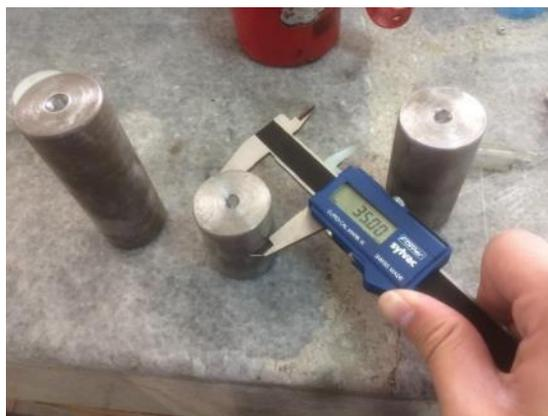
**Figura 70** Verificación de medidas de masa cilíndricas de prueba.
