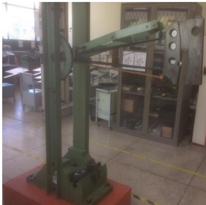
**Figura 80** Altura de caída del martillo-Ensayo Charpy.
