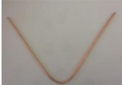
**Figura 85** Alambre de cobre luego del ensayo Charpy.
