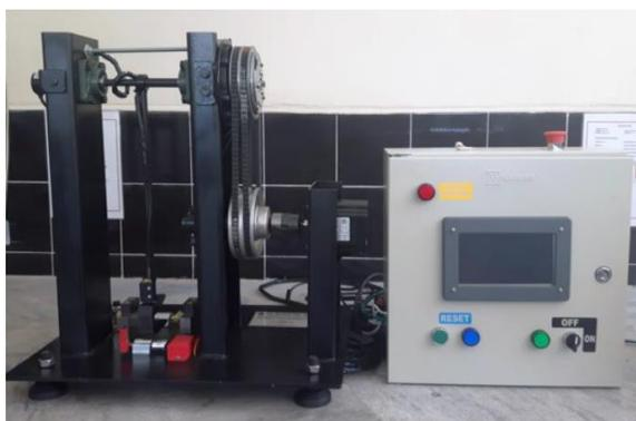
**Figura 60** Equipo de ensayo tipo Charpy.
