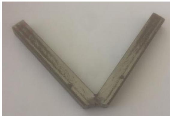
**Figura 89** Probeta de Acero ASTM A36 después del ensayo estático.
