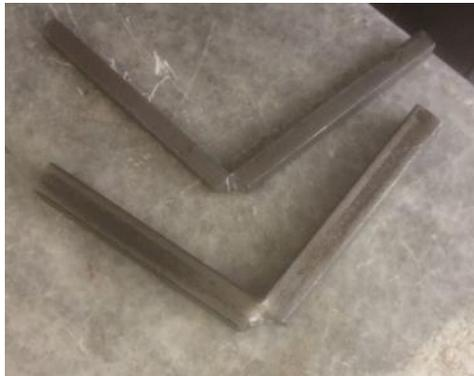
**Figura 81** Probetas ASTM A 36 luego del ensayo Charpy.
