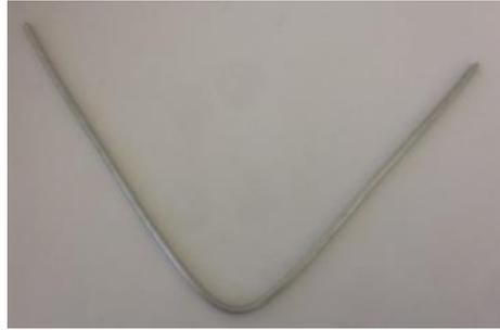
**Figura 86** Cable de acero inoxidable después del ensayo Charpy.
