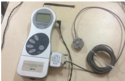
**Figura 57** Equipo: Quantrol “Advanced Force & Torque Indicador-AFTI”
