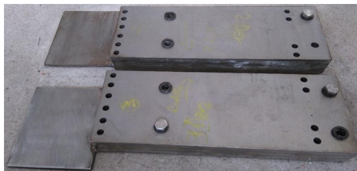
Figura 72: Planchas base de estructura construidas
