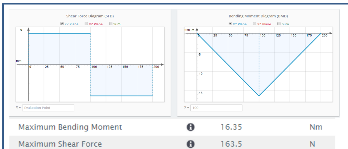
Figura 34: Momento y cortante máximo en el rodillo laminador
