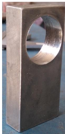
Figura 74: Parante de soporte para ejes deslizantes construido
