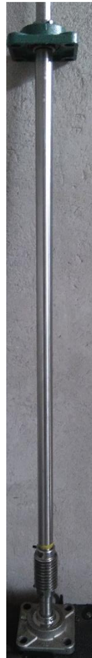
Figura 82: Eje de transmisión acoplado a las chumaceras y sinfín
