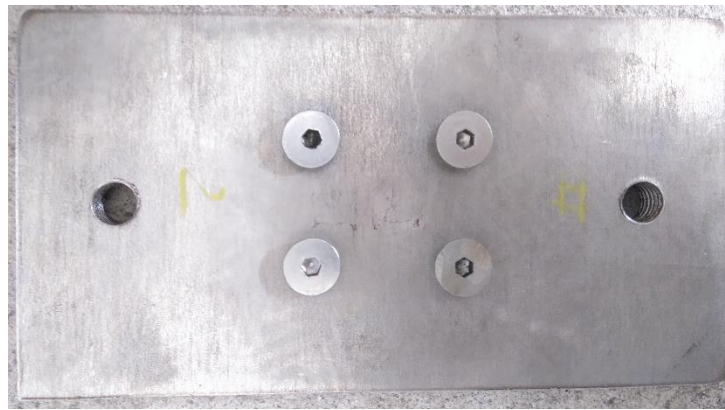
Figura 73: Plancha base de soporte construida
