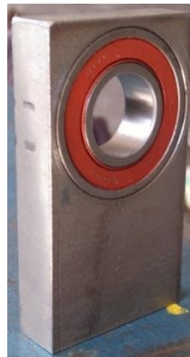
Figura 75: Parante de soporte para tornillo sinfín de avance
