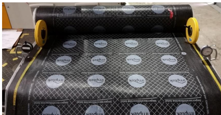
Figura 96: Medición de espesor del producto final
