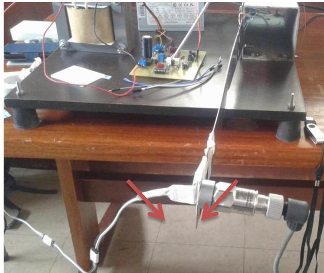
**Figura 40:** Montaje de los dos acelerómetros en el mismo punto.
