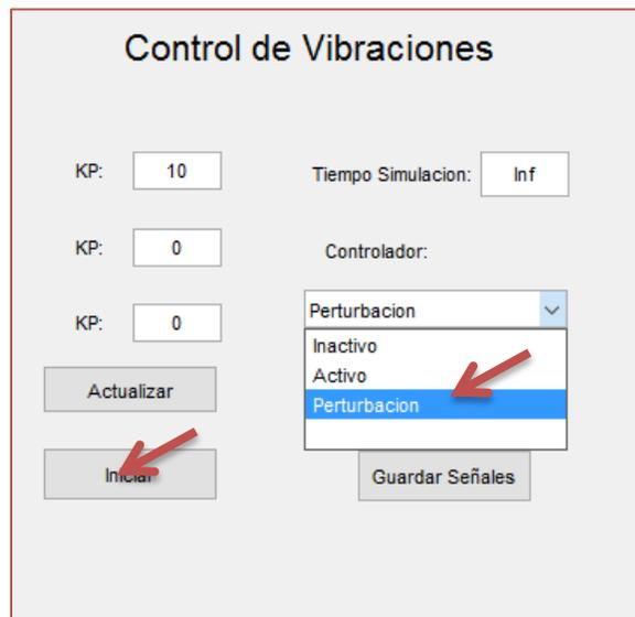
**Figura 33:** Iniciar la vibración.
