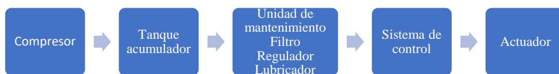
Figura 12 Sistema de aire comprimido tratado
