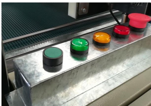
Figura 54 Componentes de señalización
