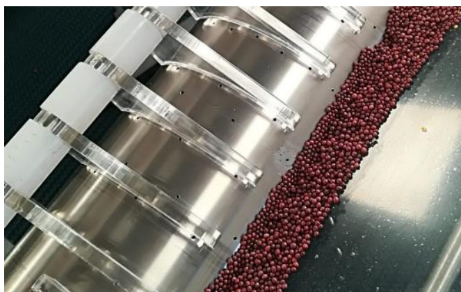
Figura 29 “Concepto A” para eliminación de grupo de semillas
