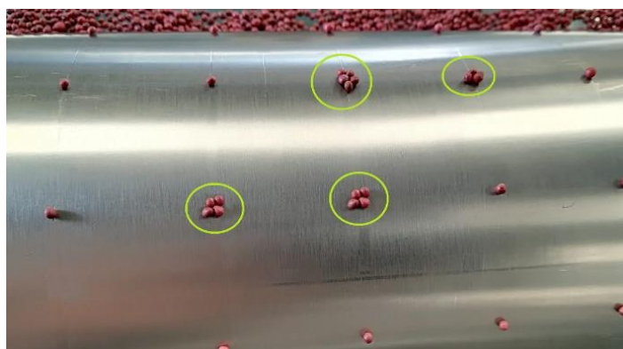
Figura 28 Semillas agrupadas en el cilindro
