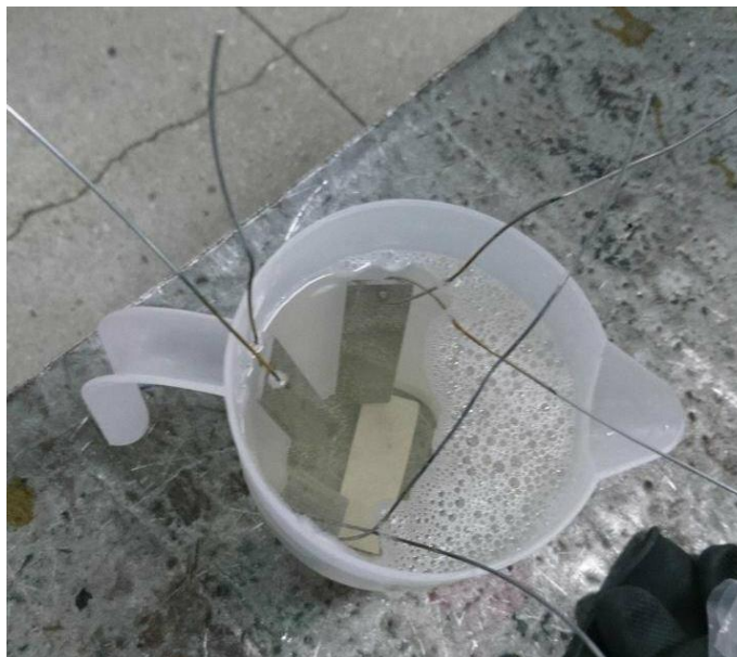
Figura 60 Decapado de probetas en mezcla de ácido clorhídrico con ácido sulfúrico
