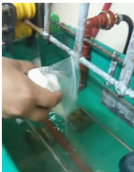
Figura 62 Mezcla de sales para la solución de Zinc Ácido
