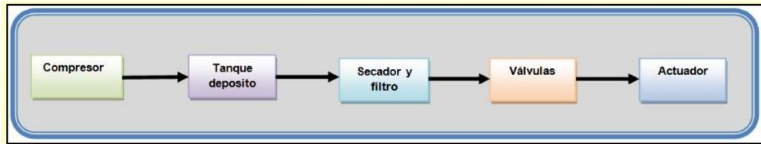
Figura 6 Circuito neumático básico
