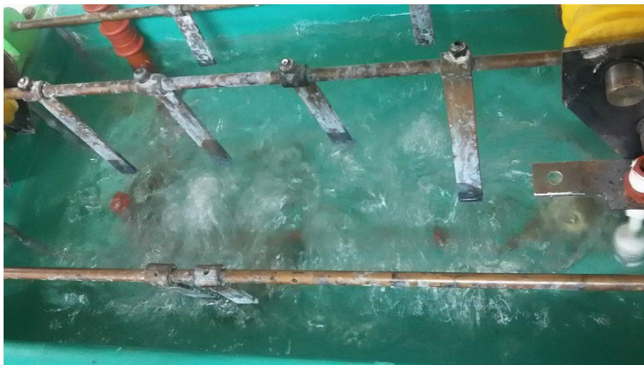
Figura 51 Verificación de la agitación de la solución
