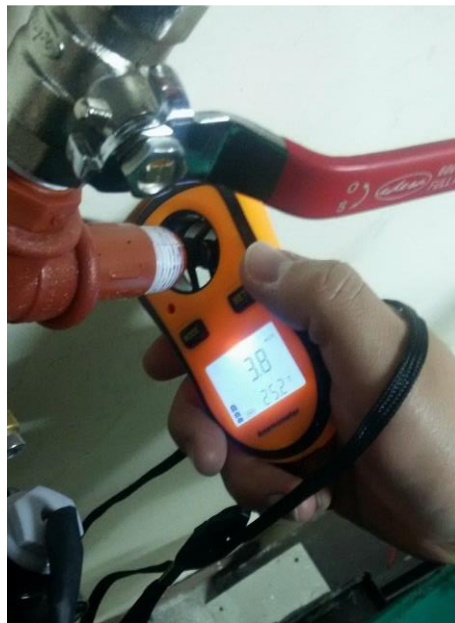
Figura 50 Medición de la velocidad de entrada del aire al sistema de agitación neumática
