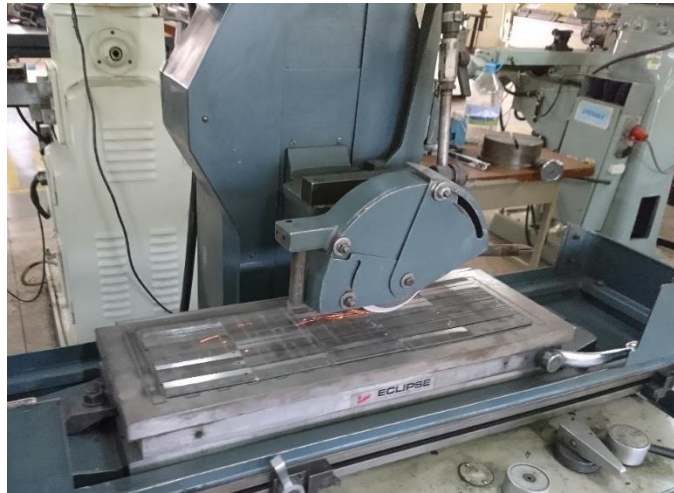
Figura 59 Rectificado de probetas
