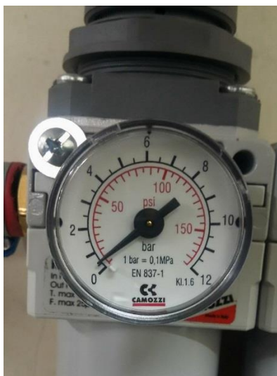
Figura 49 Presión de 0,5 bares en manómetro
