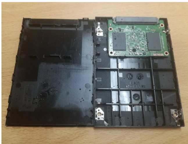
Figura 88 SSD daño físico por agua durante 10 segundos
