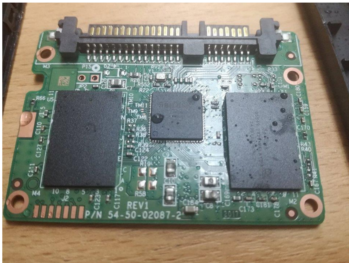
Figura 89 SSD reparación física temporal debido a agua
