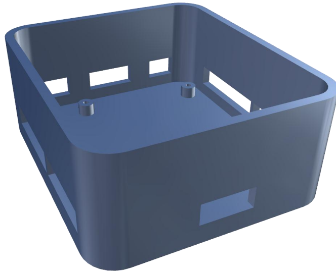
Figura 95 Contenedor del PCB: Procesador Central. Anexo: 8.
