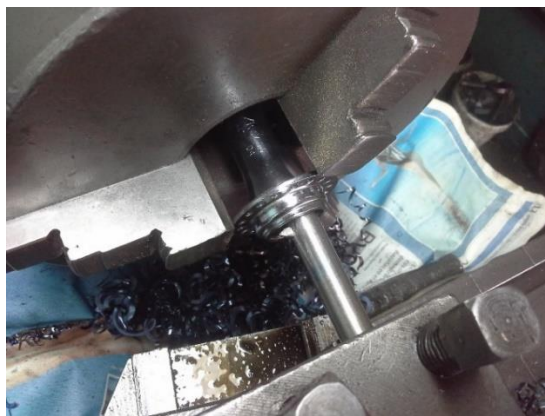
Figura 76 Proceso de mandrinado en la cara lateral de manzana
