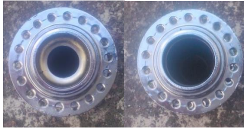
Figura 77 En la izquierda se muestra la manzana antes del mecanizado, a la derecha se muestra la manzana ya mecanizada
