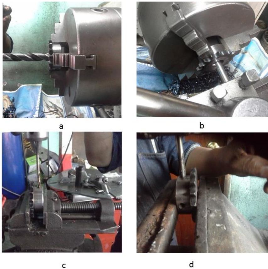
Figura 78 Procesos de manufactura realizada en el piñón, a) Taladrado agujero central, b) Mandrinado, c) Taladrado para pasadores, d) Machuelado.
