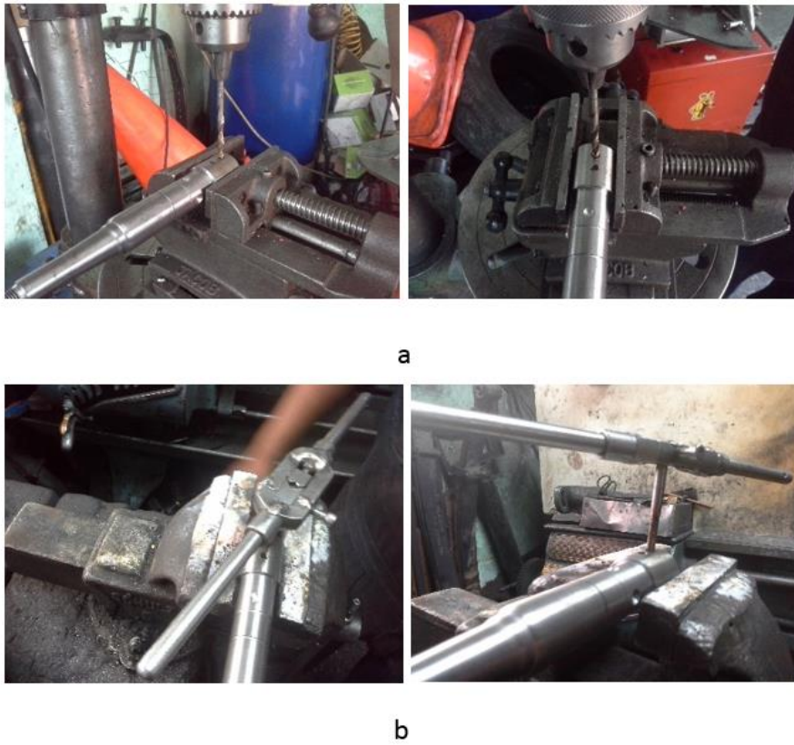
Figura 72 Se muestra las operaciones realizadas para los pasadores roscados M6 a) Taladrado, b) Machuelado
