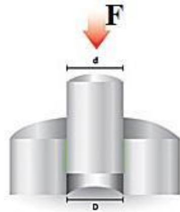
Figura 4 Ensamble por interferencia, D < d
