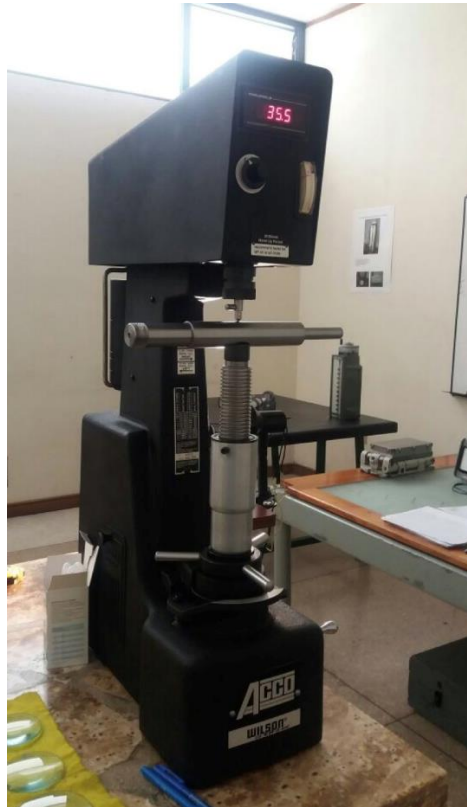
Figura 62 Dureza del eje para aumento.
