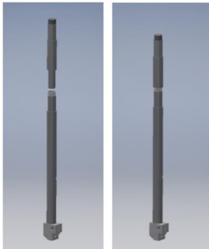
Figura 46 Solución aumento eje por interferencia mecánica
