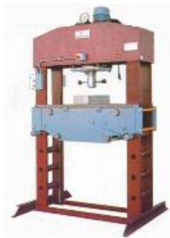
Figura 12 Prensa Hidráulica, métodos para montar y desmontar piezas con ajustes a presión Fuente a (Makielezzo, 2009)
