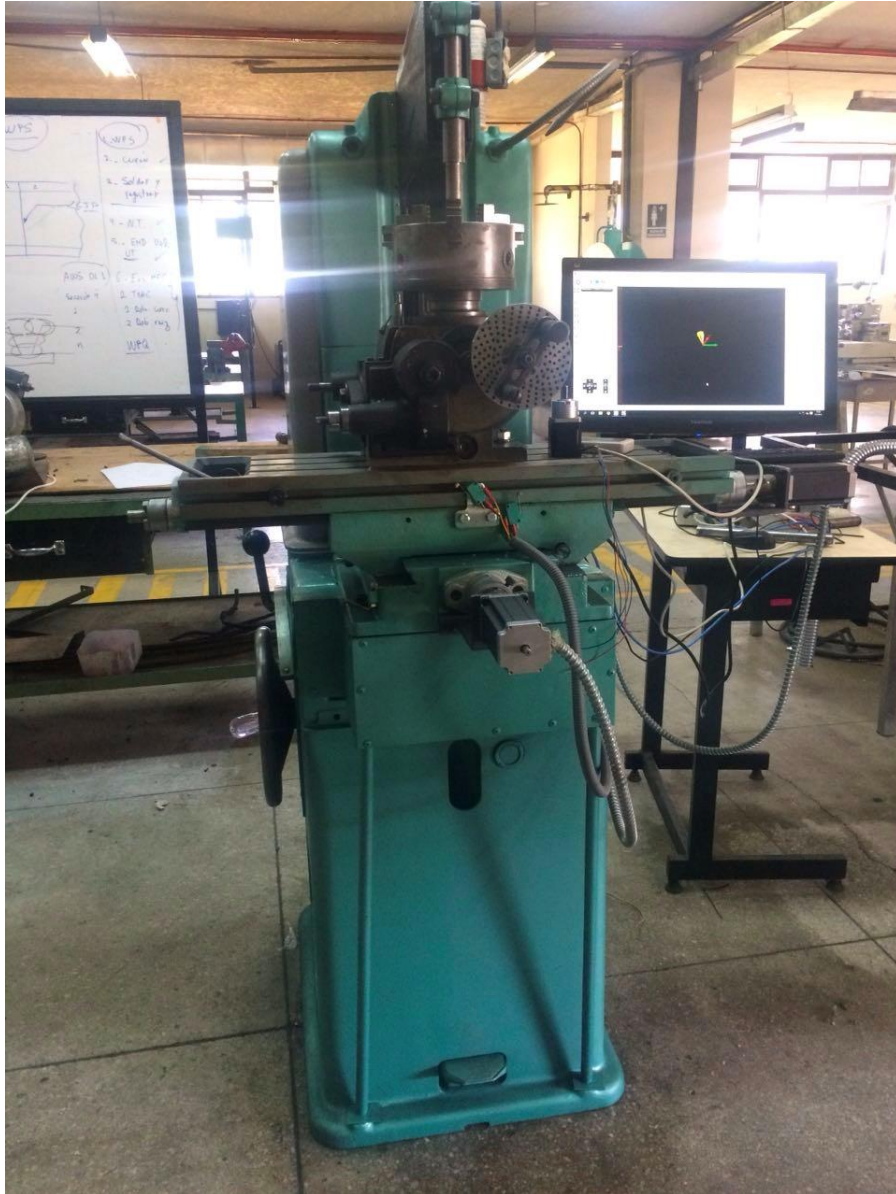
Figura 77 Sistema conjunto implementación máquina mortajadora CNC
