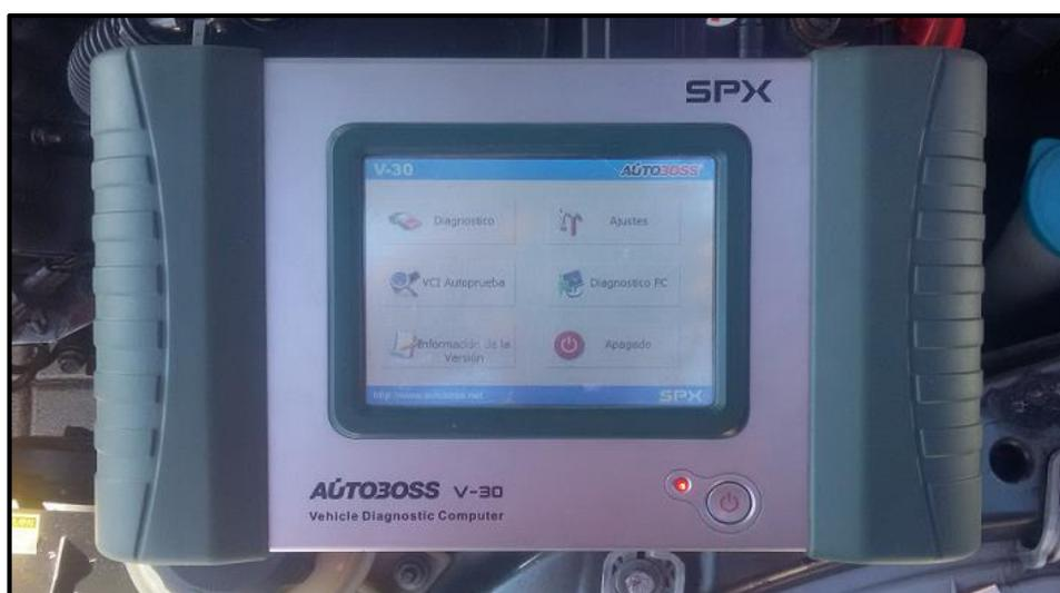
Figura 85. Interfaz gráfica del scanner AUTOBOSS V-30
