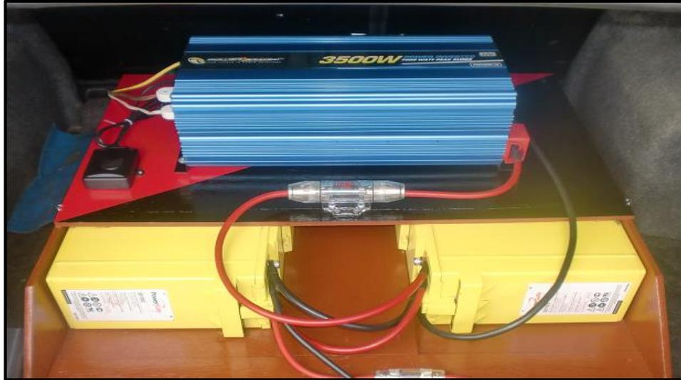
**Figura 71. Implementación y conexión de la fuente de alimentación**
