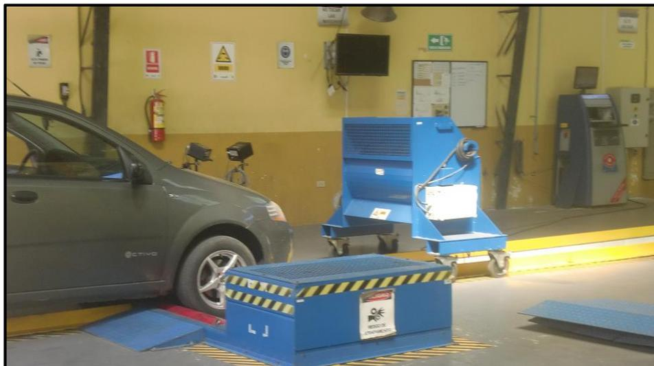
Figura 17. Dinamómetro de rodillo LPS 3000 y sus componentes
