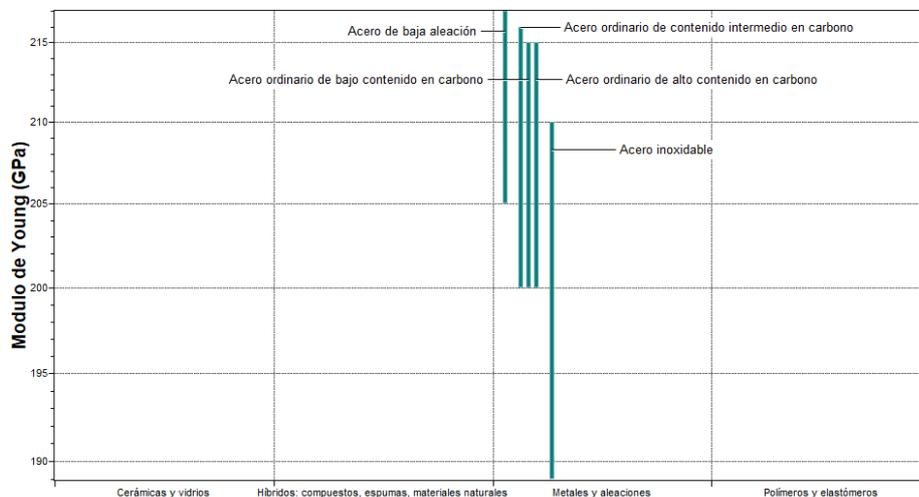
**Figura 52. Material para carcasa de protección**
