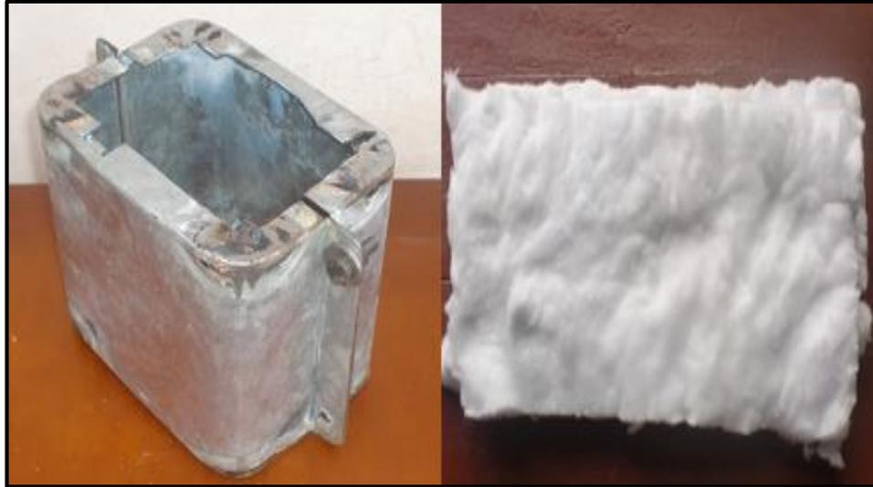
**Figura 55. Carcasa metálica y aislante térmico**
