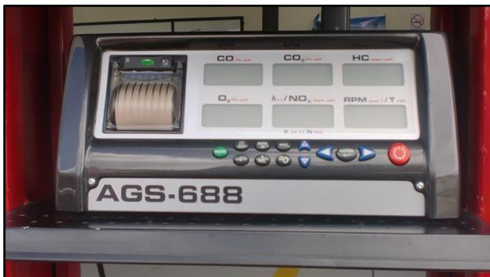
Figura 21. Analizador de gases AGS-688
