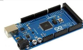
Se seleccionó la placa de desarrollo Arduino MEGA que trae incorporado el microcontrolador ATmega2560 porque satisface con la demanda de puertos analógicos y digitales necesarios para las conexiones de dispositivos empleados, además la memoria SRAM es más amplia asegurando la compilación y ejecución de un algoritmo de programación más extenso.
