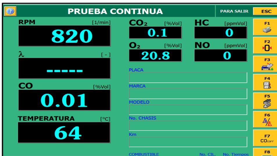
**Figura 83. Resultados de la medición continua con analizador de gases AGS-688**
