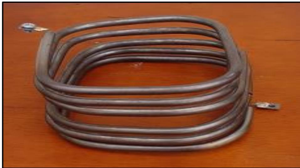
**Figura 44. Bobina de resistencia**
