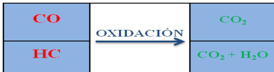
**Figura 7. Proceso de oxidación en catalizador de dos vías**
