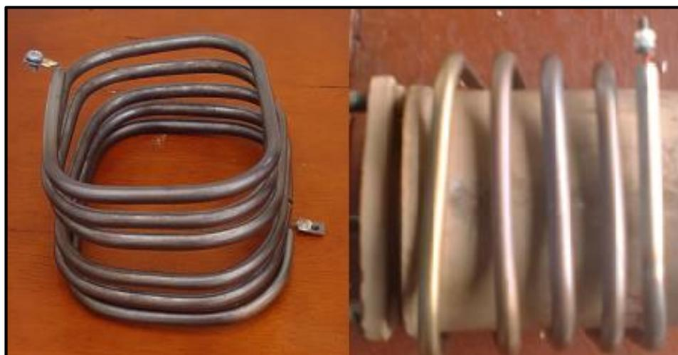
**Figura 54. Bobina de resistencia y montaje en catalizador**
