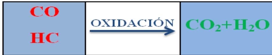
**Figura 6. Proceso de oxidación en catalizador de una vía**
