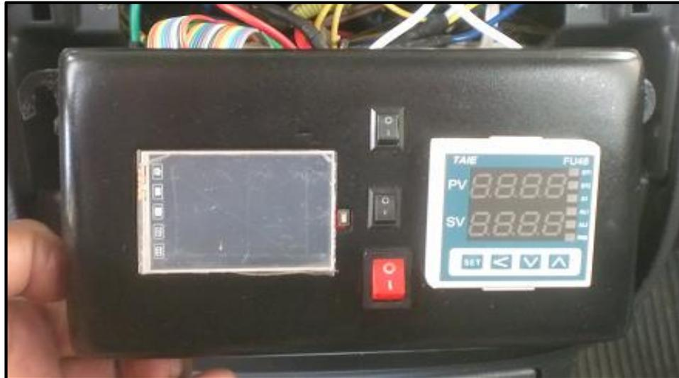
**Figura 73. Montaje y conexión de la interfaz gráfica y controlador electrónico de temperatura**
