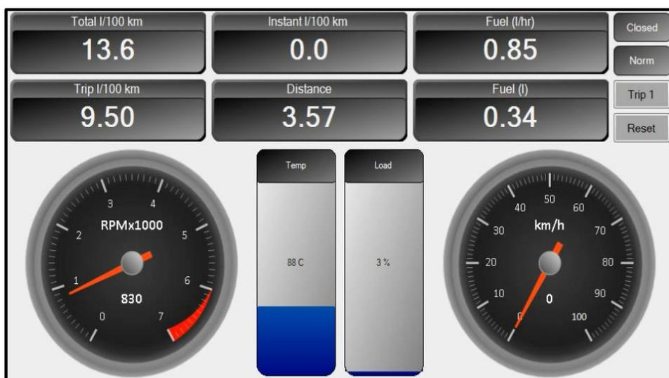
**Figura 84. Interfaz gráfica de medición del software OBDwiz**
