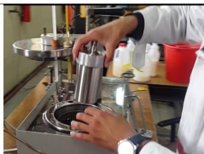
**Figura 70. Colocación la bomba de combustión**
