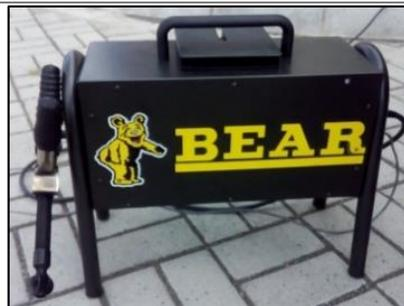
Figura 105. Opacímetro calibrando
