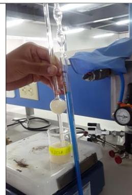
**Figura 58. Llenado del bulbo del viscosímetro**
