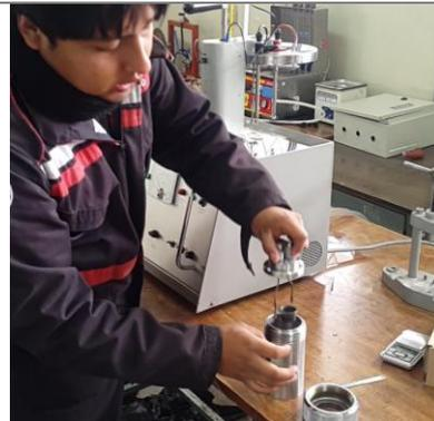
Figura 75. Despresurización y desarme de la bomba calorimétrica
