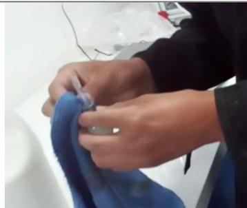
Figura 50. Secado del picnómetro
