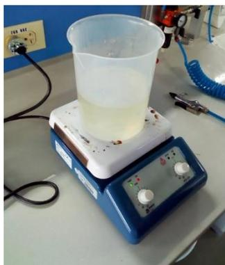
**Figura 23. Agitador electromagnético Boeco MSH 420**
