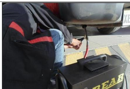
Figura 107. Sonda de opacímetro
