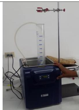
**Figura 57. Sistema para mantener la temperatura estable**
