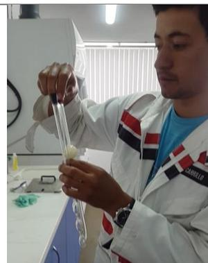
**Figura 59. Colocación de los tapones en el viscosímetro**
