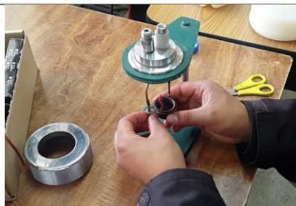
**Figura 68. Armado de la bomba de combustión**
