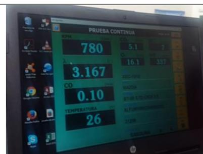
Figura 87. Datos de prueba de emisiones a ralentí
