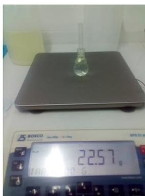
**Figura 25. Picnómetro****a. Utilización**
