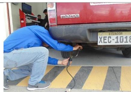
Figura 86. Sonda lambda en escape del vehículo
