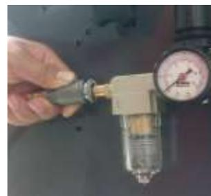
Figura 46: Acoplador neumático
