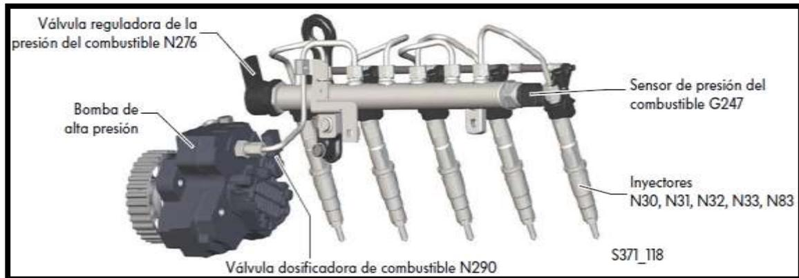
**Figura 6: Sistema de alimentación de alta presión CRDI Bosch**
