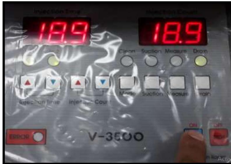
**Figura 33: Prueba de resistencia del inyector piezoeléctrico en el banco de pruebas V-3500 Bosch**
