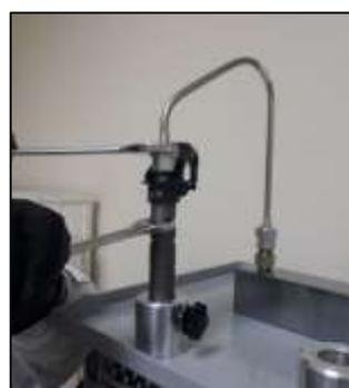
Figura 78: Desacoplamiento del inyector
