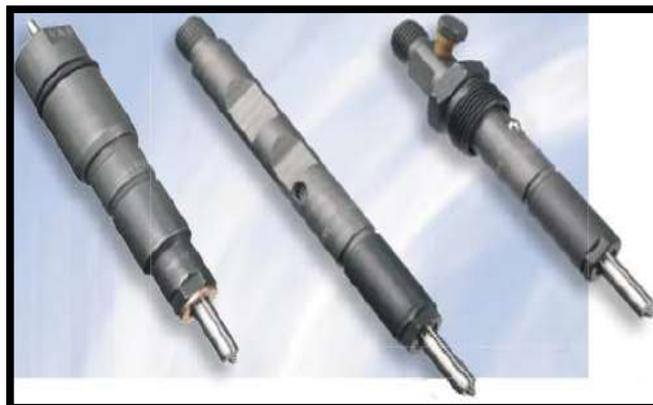
**Figura 24: Porta inyectores Bosch**
