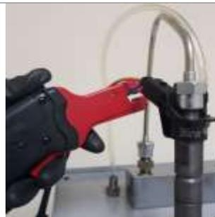
Figura 84: Montaje de la pinza amperimétrica
