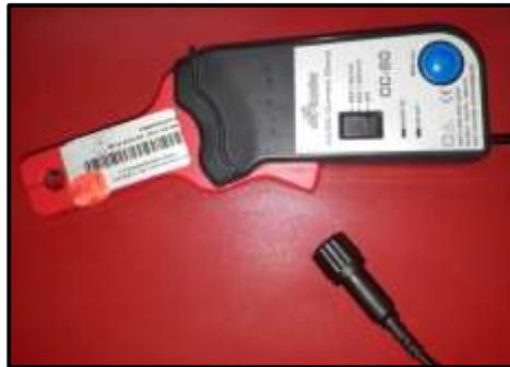
**Figura 37: Pinza Amperimétrica**
