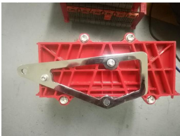
**Figura 55. Sujeción placas laterales**
