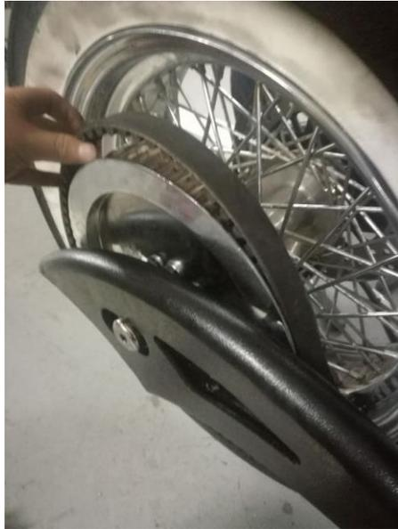
**Figura 52. Instalación de la banda de transmisión**
