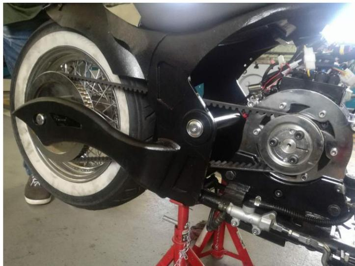
**Figura 53. Sistema de propulsión instalado**
