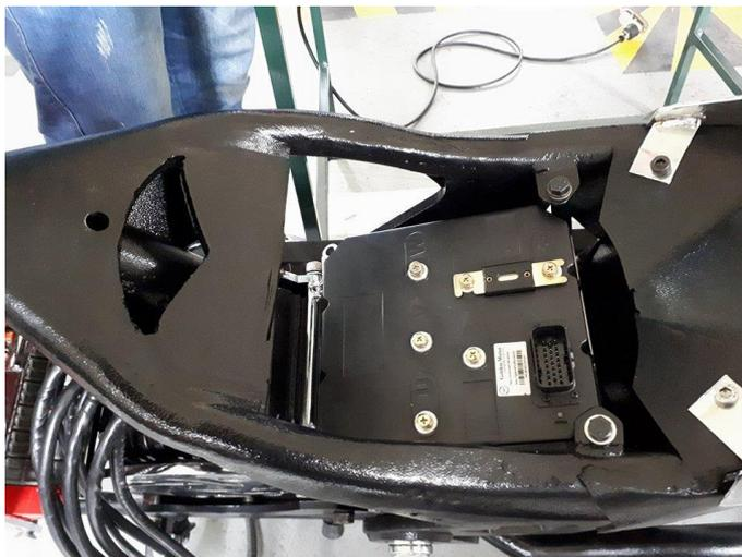
**Figura 57. Instalación módulo de control**
