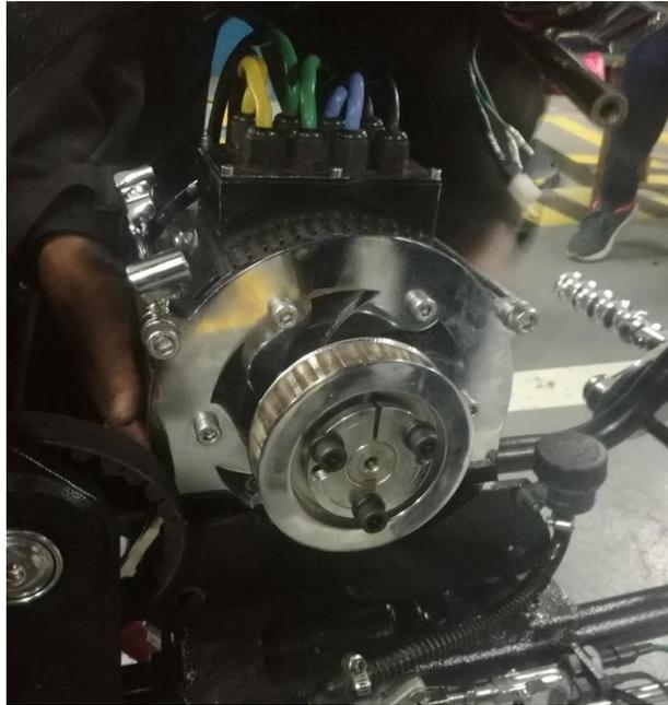
**Figura 50. Montaje motor eléctrico**
