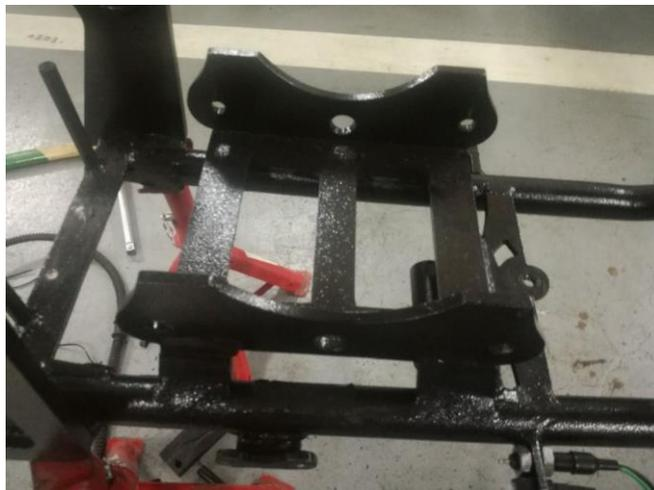
**Figura 48. Fijación bases motor**
