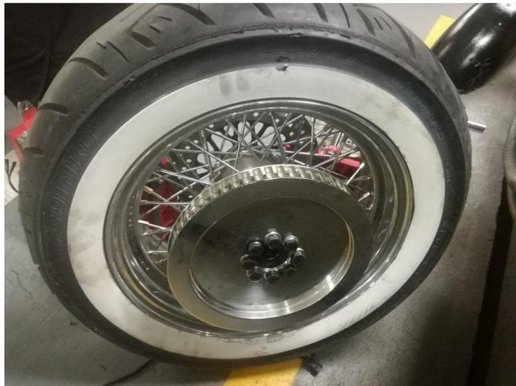
**Figura 51. Implementación polea conducida**
