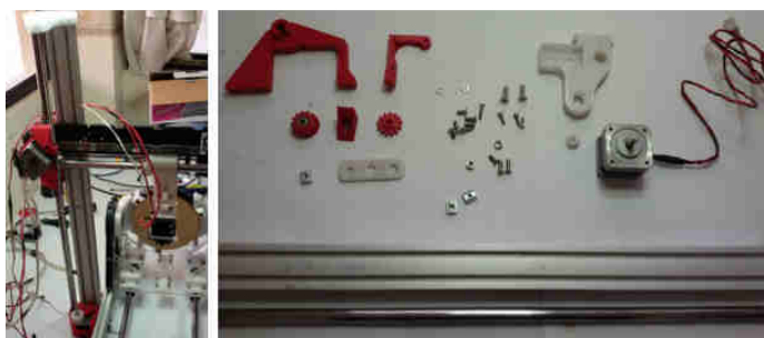
Figura 118. Montaje y componentes del mecanismo del eje Z
