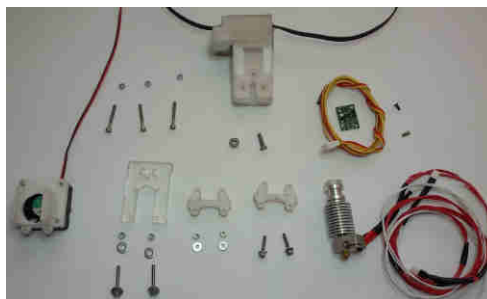
Figura 109. Elementos de todo el sistema de extrusión de material
