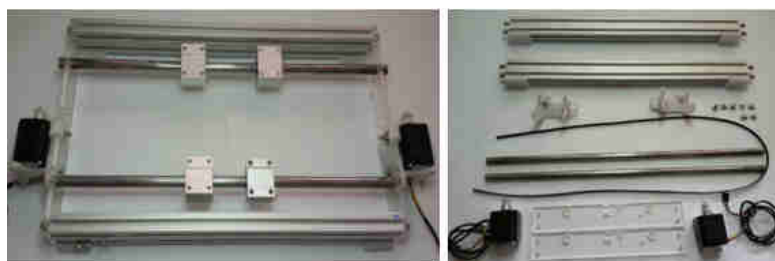
Figura 113. Montaje y elementos del sistema de guiado de Y (plataforma base)
