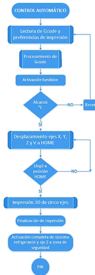
Figura 107. Diagrama de flujo para control automático de impresión
