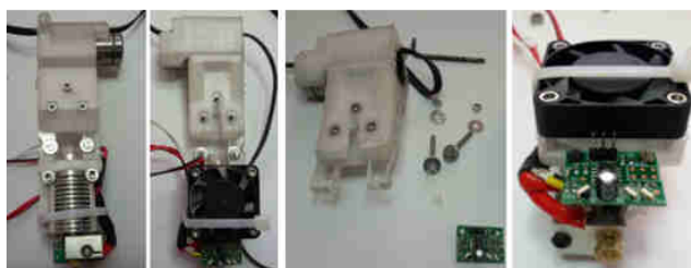
Figura 111. Montaje del Hot End y su soporte
