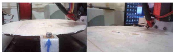
Figura 134. Ubicación del punto de referencia desplazado para X positivo
