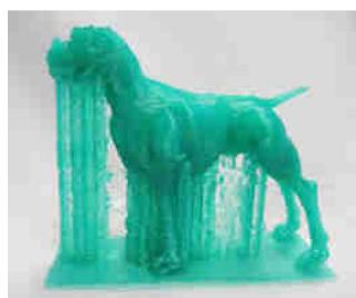
Figura 7. Uso de material de apoyo en pieza impresa.
