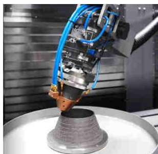
Figura 18. Máquina de fabricación aditiva y mecanizado ADD+PROCESS
