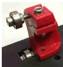
Figura 121. Montaje corredizo del eje Z
