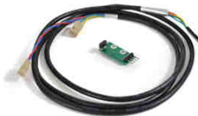
Figura 80. Sensor infrarrojo "Mini IR Sensor"
