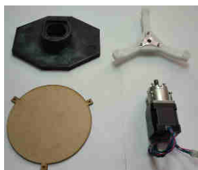
Figura 117. Componentes del sistema giratorio del eje C
