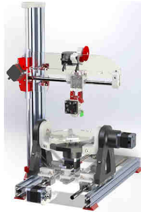
Figura 88. Ensamble final del diseño CAD del prototipo
