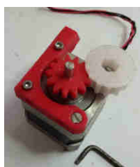
Figura 119. Montaje del motor del eje Z
