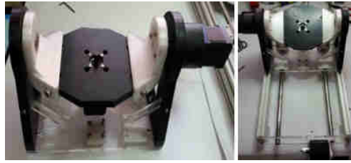
Figura 115. Cama de deposición de material giratoria basculante
