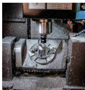
Figura 21. Centro de mecanizado de cinco ejes
