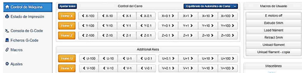
Figura 94. Configuración de controladores para los ejes X, Y, Z, U, V
