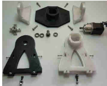
Figura 116. Componentes del sistema basculante del eje A
