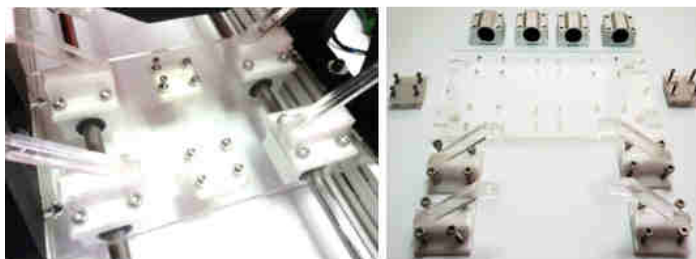
Figura 114. Montaje de la estructura soporte de la plataforma móvil Y
