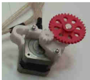
Figura 110. Montaje del cuerpo extrusor
