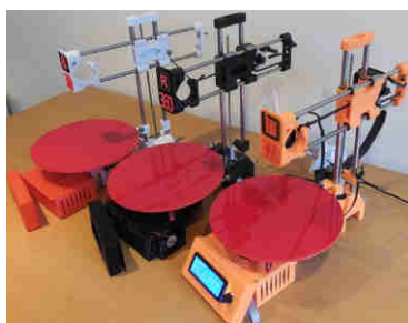
Figura 34. Cama de geometría circular adoptada por impresoras 3D polares
