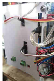
Figura 124. Fácil conexión y desconexión para motores PaP y finales de carrera
