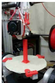
Figura 150. Viga para prueba de mejora en resistencia mecánica
