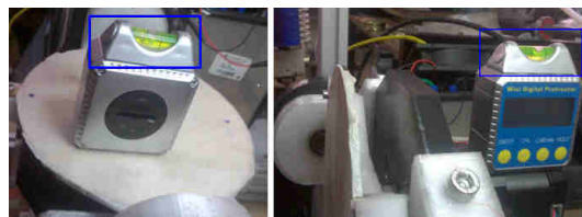
Figura 142. Movimiento basculante satisfactorio del eje A
