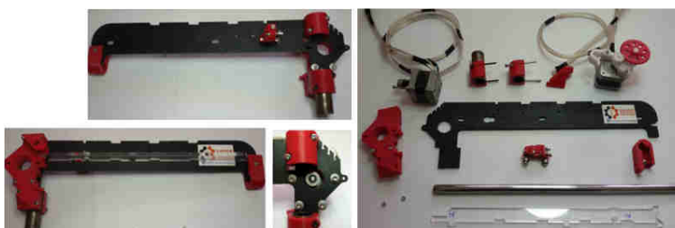
Figura 112. Montaje y elementos del eje X
