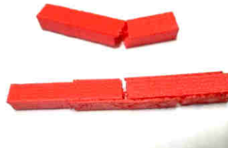
Figura 154. Piezas de prueba después de los ensayos de rotura
