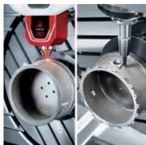
Figura 17. Integración de tecnología fabricada por DMG MORI Soldadura de deposición láser y fresado de 5 ejes.
