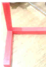
Figura 140. Pieza de prueba para ortogonalidad de los ejes
