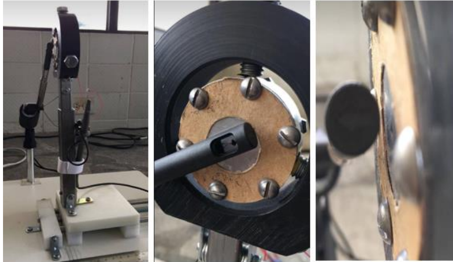
Figura. 15 Fotografía de banco de pruebas para medición de velocidad de flujo
