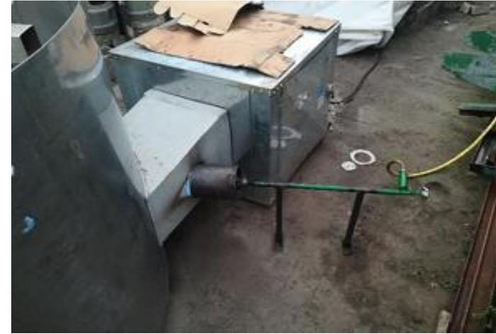
**Figura 8 Adaptación del quemador**
