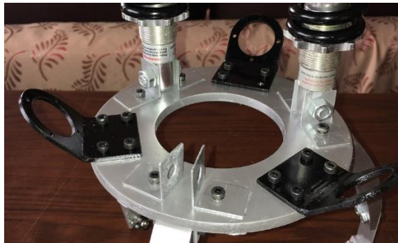
Figura 115. Sub ensamble acople de motor con el chasis
