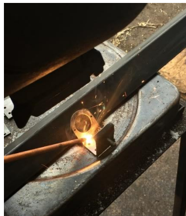
Figura 113. Proceso de soldadura de acople de motor
