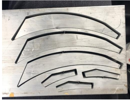
Figura 104. Corte chorro de agua de la garra
