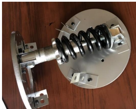
Figura 108. Sub ensamble amortiguador con el chasis
