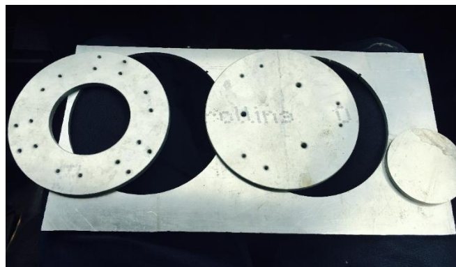
Figura 101. Corte chorro de agua del chasis
