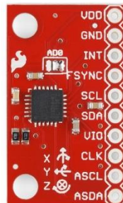
Figura 93 Detalle IMU MPU6050
