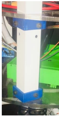
Figura 119. Sub ensamble acople con el perfil
