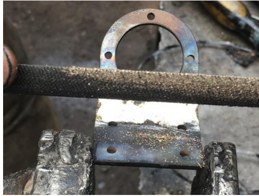
Figura 114. Limado de exceso de suelda
