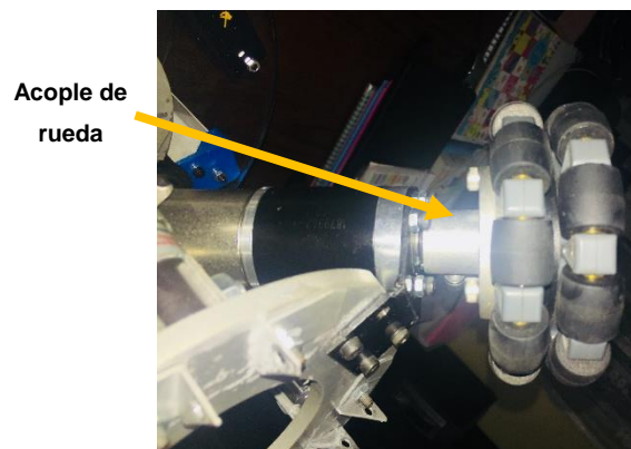
Figura 117. Sub ensamble motor, reductor, acople y rueda
