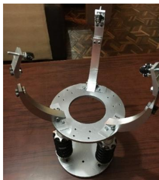
Figura 106. Sub ensamble garras con chasis
