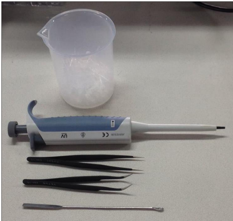
Figura 19 Materiales utilizados para manipulación de Aceites Esenciales en el Analizador Termogravimétrico (TGA).
