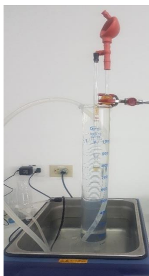
Figura 12. Equipo armado para determinar la viscosidad cinemática.
