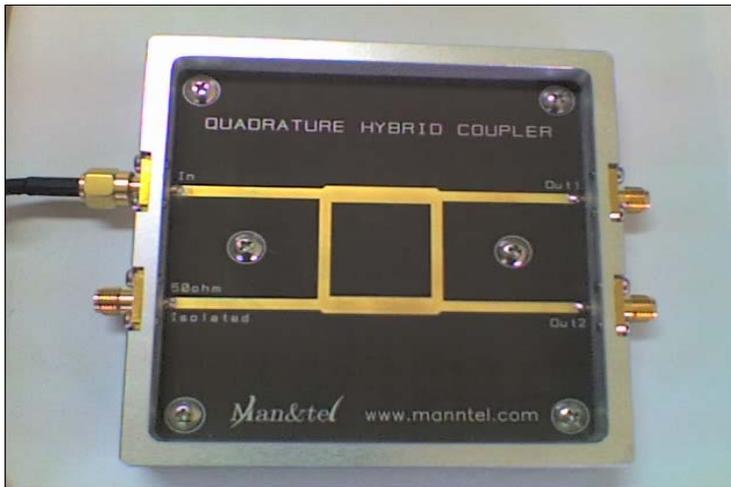
**Figura. 3.17** Fotografía de un acoplador híbrido en cuadratura
