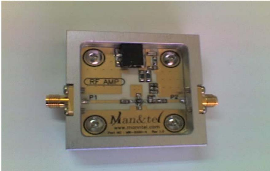
Figura. 3.3 Fotografía del módulo amplificador RF
