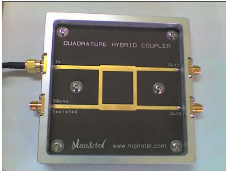
**Figura. 8.19** Fotografía del acoplador híbrido
