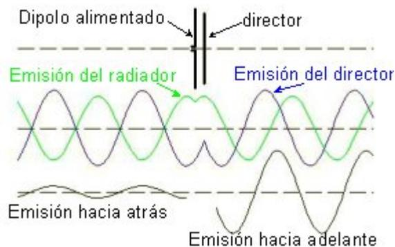
**Figura. 4.3** Funcionamiento de una antena yagi
