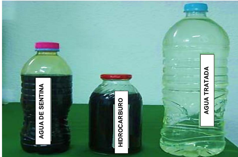
*Figura 16 Proceso y Producto de la Planta Separadora de Agua de Sentina*
