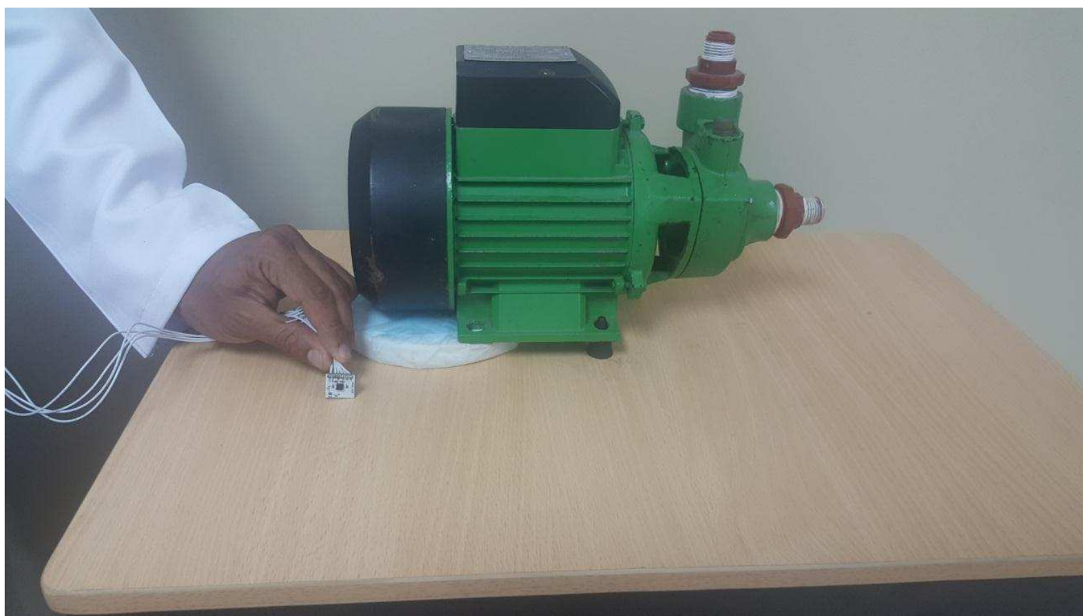
Figura 19: Toma de vibraciones sobre la mesa cuando la bomba esta con soporte de goma
