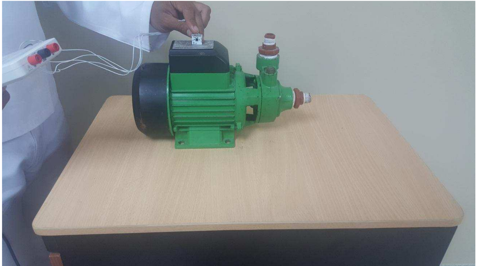
Figura 17: Medición de vibraciones sobre la bomba sin soporte de goma
