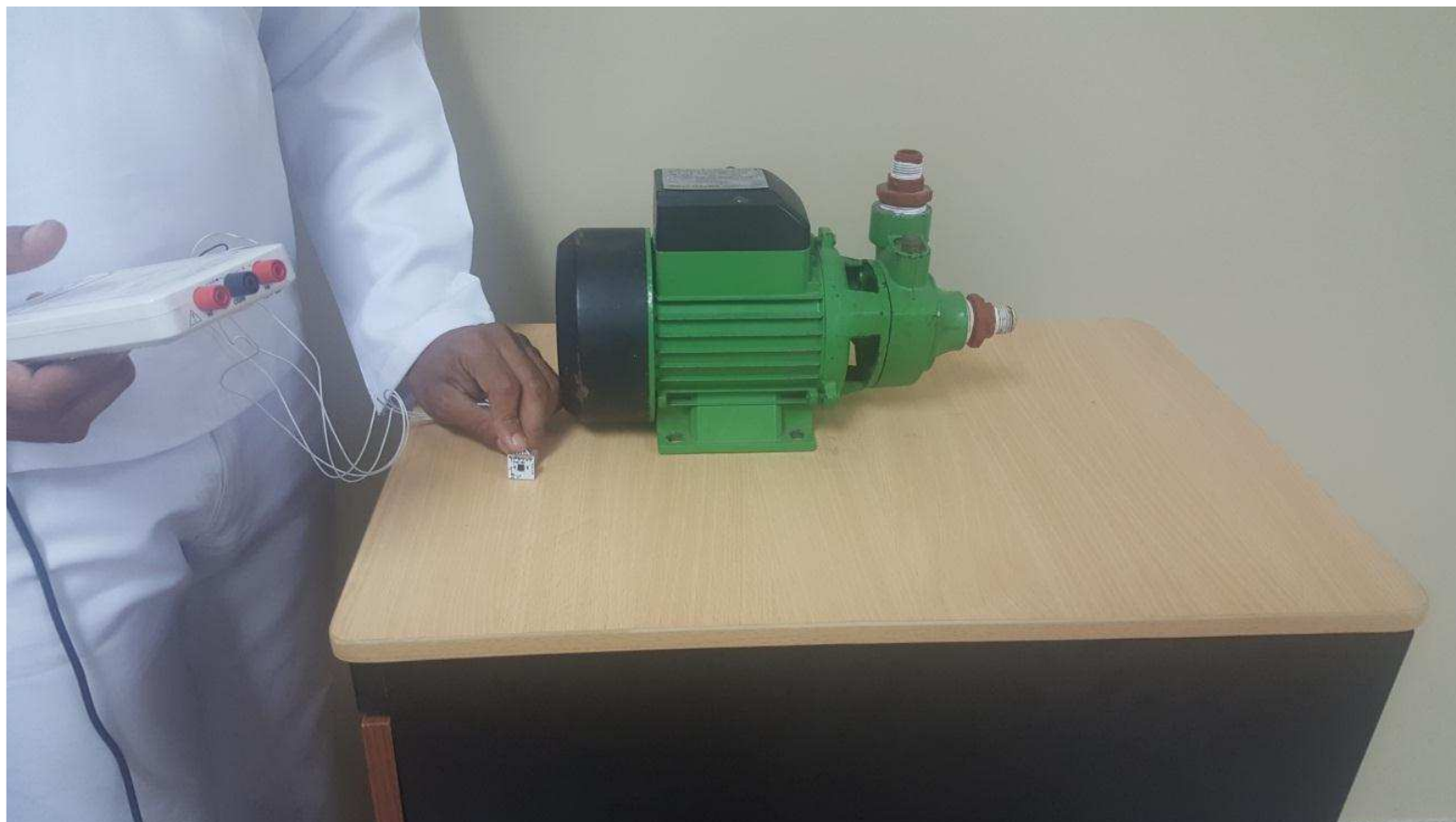
Figura 21: Toma de vibraciones sobre la mesa cuando la bomba esta sin soportes de goma
