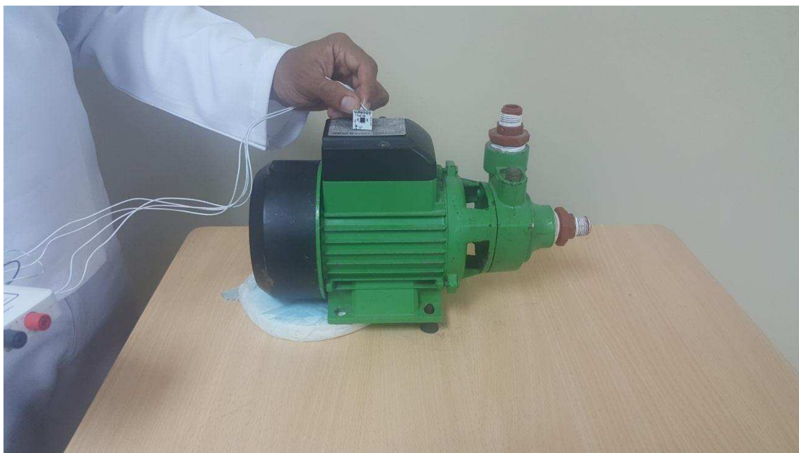
Figura 15: Medición de vibraciones sobre la bomba con soportes de goma
