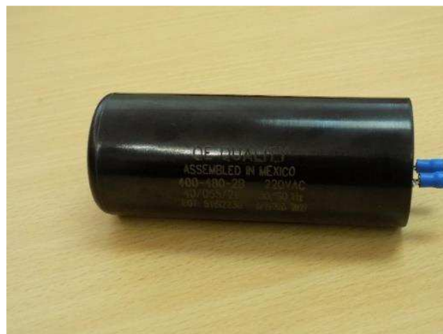
Figura 17 Capacitor de trabajo o marcha
