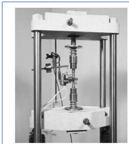
**Figura 5** Máquina de ensayos de tensión.
