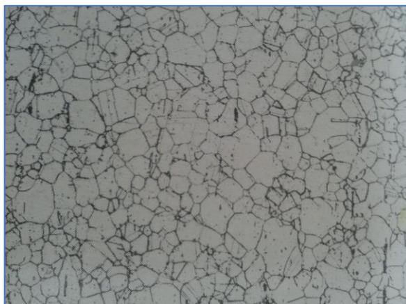
**Figura 2** Estructura metalográfica del acero inoxidable
