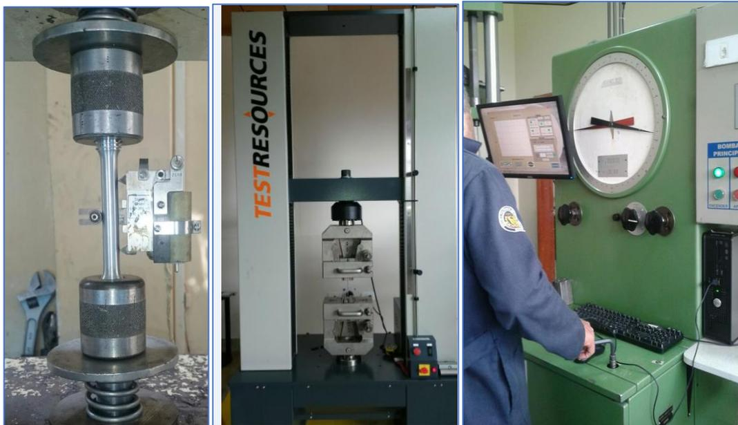
**Figura 26** Máquinas universales de ensayos
