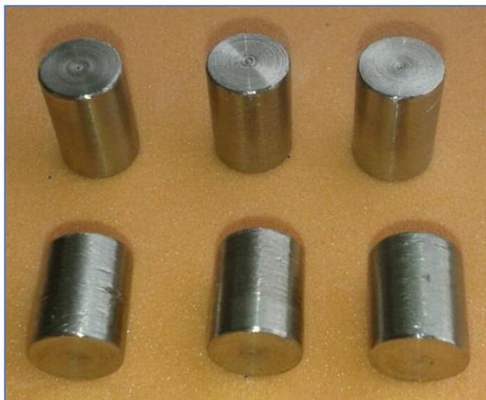
**Figura 25** Probetas para compresión de duraluminio y acero inoxidable.
