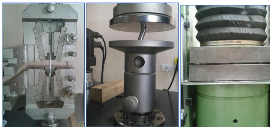
**Figura 27** Mordazas utilizadas para tracción y compresión
