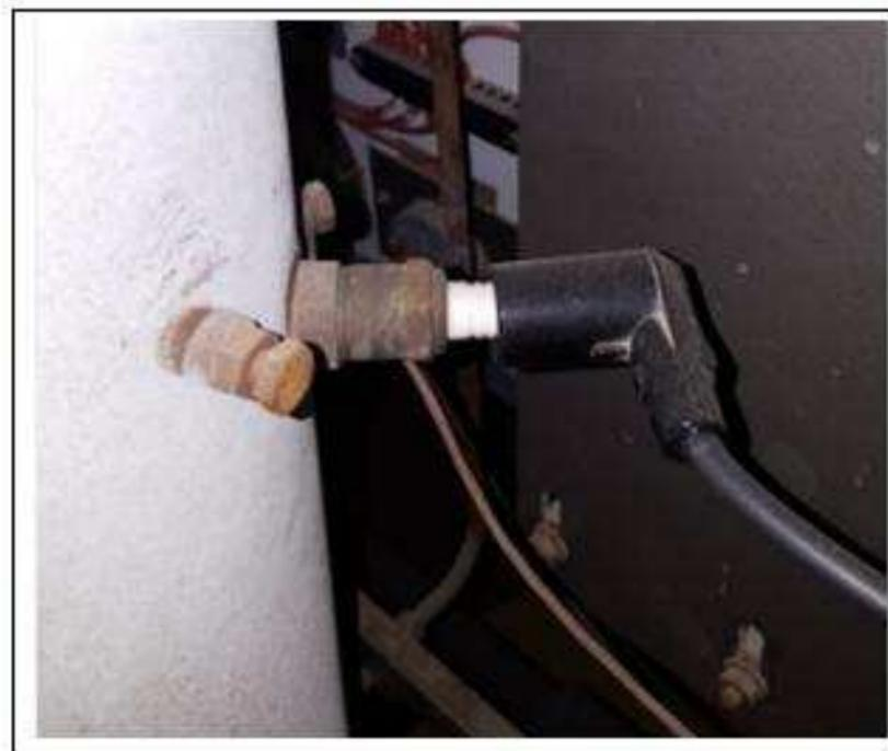
**Figura 23:** Colocación de bujía
