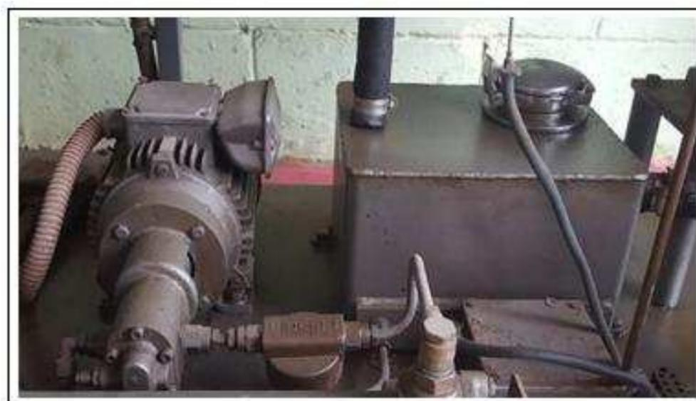
**Figura 17:** Sistema de lubricación
