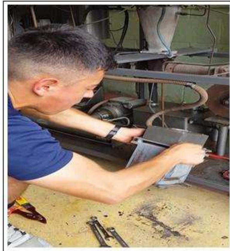
**Figura 26:** Fijación del transformador
