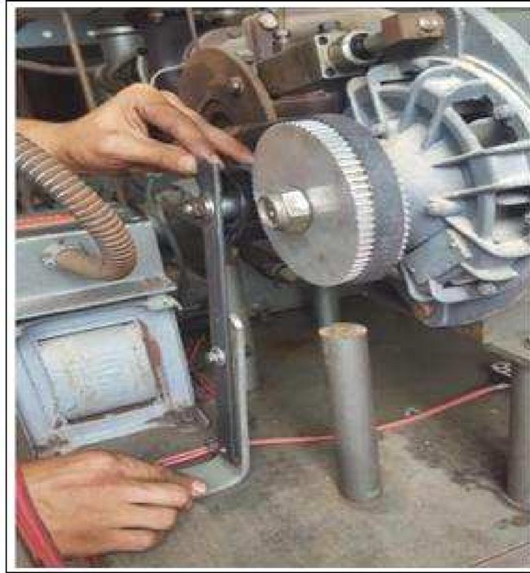
**Figura 28:** Montaje de bandas y tensores de banda
