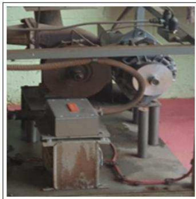
**Figura 14:** Partes afectadas por oxidación
