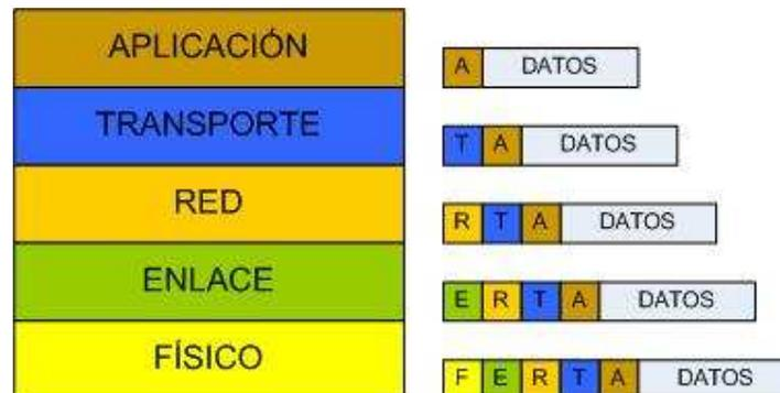
**Figura. 2.10. Paquetización en TCP/IP**<sup>[18]</sup>
