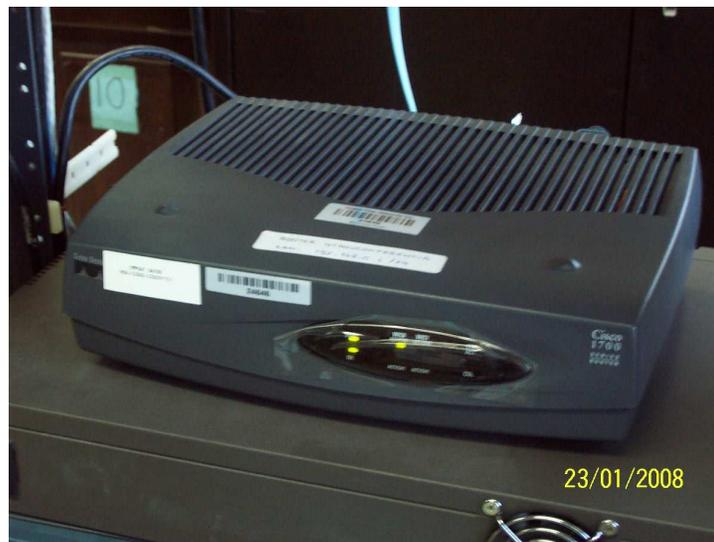
Figura. 3.22. Router CISCO 1721<sup>[18]</sup>
