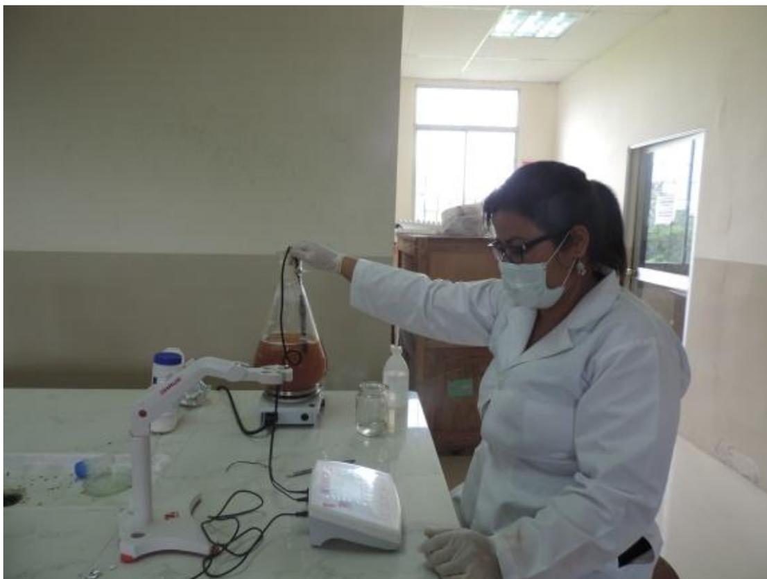
*Figura 6* Preparación de Agar y medición de pH.
