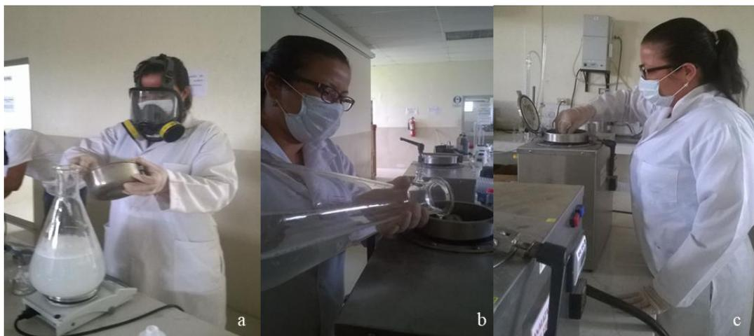
**Figura 14**FDN (a), analizador de fibra(b) y extracción (c)
