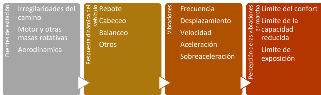
Figura 17. Fuentes de excitación de las vibraciones por los pasajeros del vehículo
