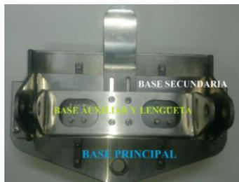
**Figura 118 Base auxiliar y lengüeta**
