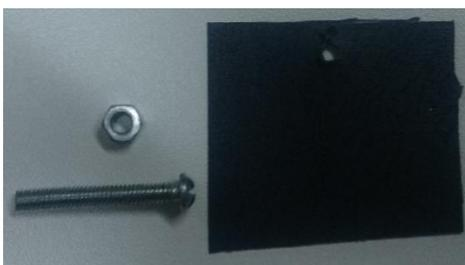
**Figura 130 Componentes de aislamiento y sujeción de placa de potencia**
