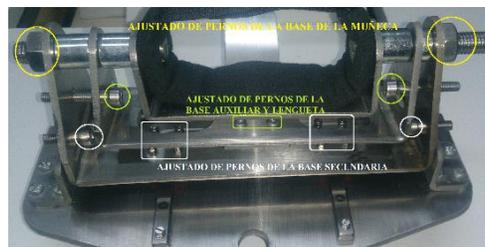
**Figura 120 Ensamblaje de bases**
