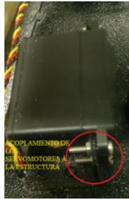
**Figura 97 Acoplamiento de los servomotores a la estructura**
