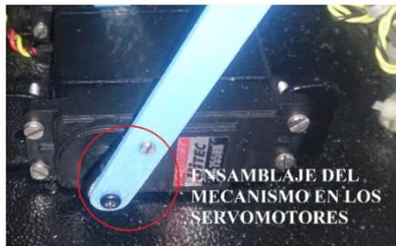
**Figura 100 Ensamblaje del mecanismo en los servomotores**
