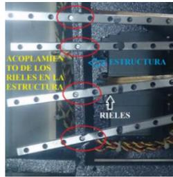
**Figura 99 Acoplamiento de los rieles en la estructura**
