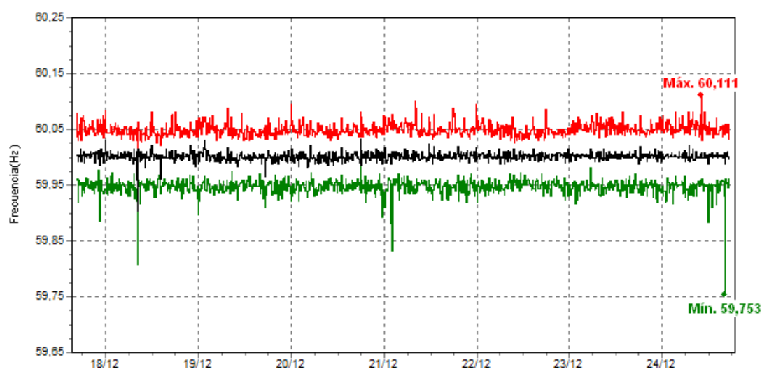
Figura 32 Grafica de frecuencia en el transformador de 75 KVA
