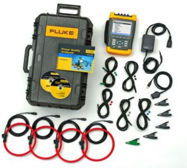
Figura 6 Analizador trifásico FLUKE 435
