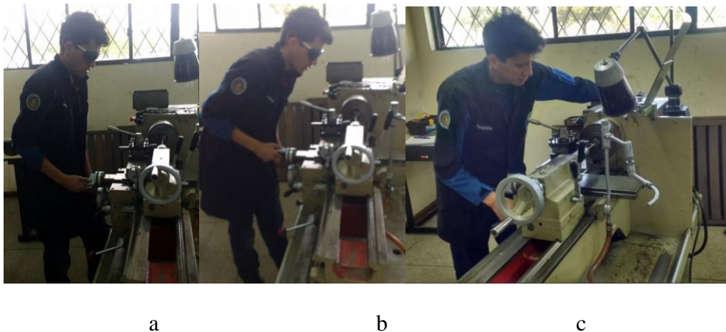
Figura 89 Torneado de Ejes a) Cilindrado de eje a 5,5mm b) cilindrado de eje a 5mm c) Limado de eje
