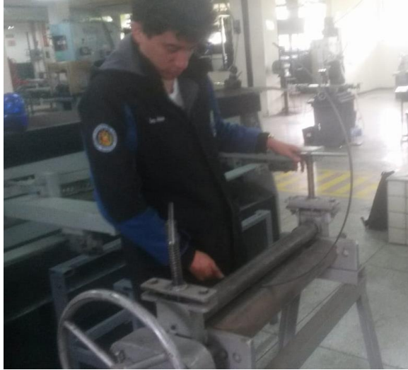
Figura 85 Barolado de plancha para Contorno del Robot
