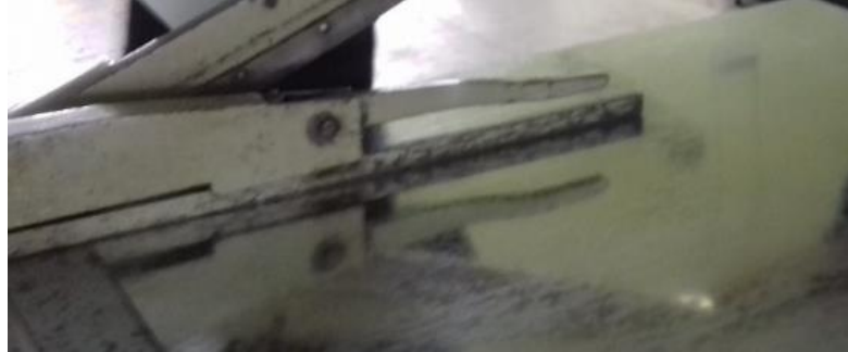
Figura 83 Corte de Acero Galvanizado 1,1mm
