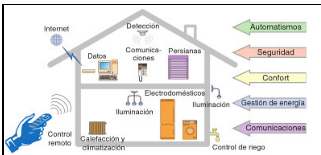
Figura 2.9.1: Esquema de una vivienda domótica Fuente: (Martín Castillo, 2009)
