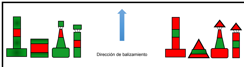
Figura 2.8 Señales de Bifurcación
