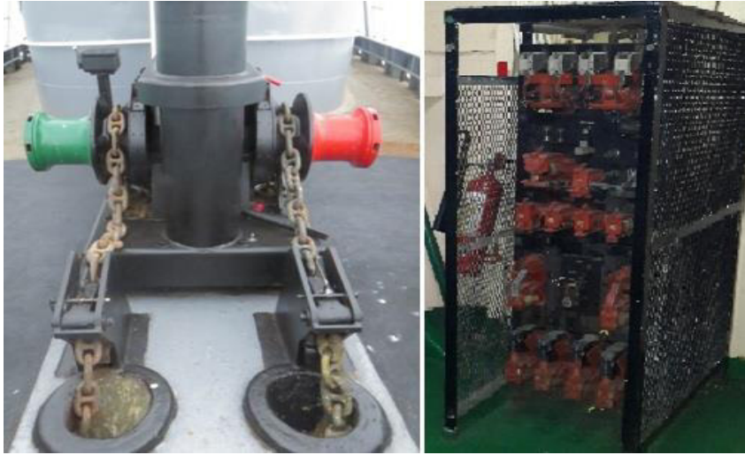
Figura 4.1 Parte mecánica y eléctrica del sistema de fondeo del BESMAR.
