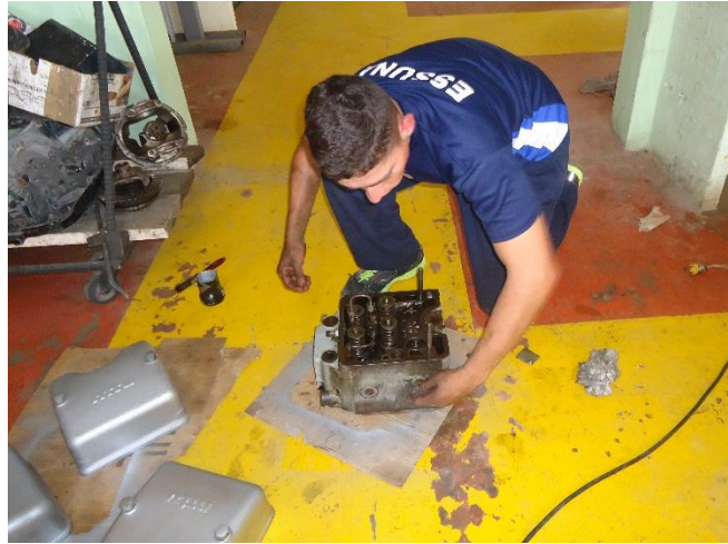
Figura 4.16. Limpieza del cabezote Fuente: Fuente: Laboratorio de Maquinaria Naval Elaborado por: El Autor
