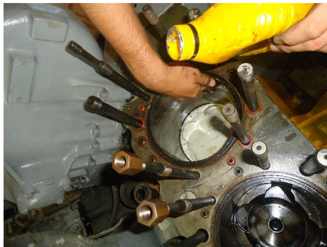
Figura 4.15. Lubricación de cilindros Fuente: Laboratorio de Maquinaria Naval Elaborado por: El Autor
