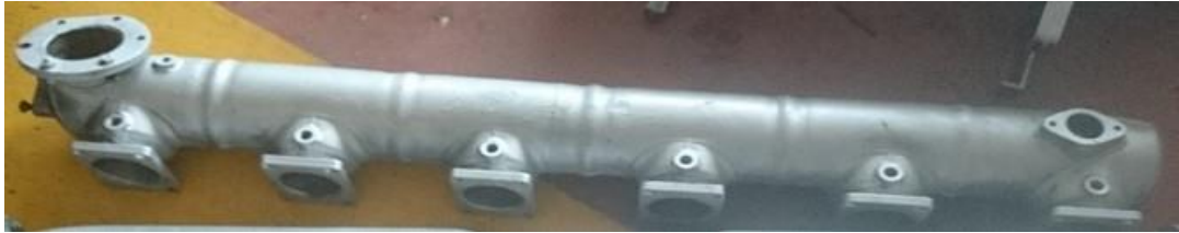
Figura 2.36. Múltiple de escape Fuente: Laboratorio de Maquinaria Naval Elaborado por: El Autor
