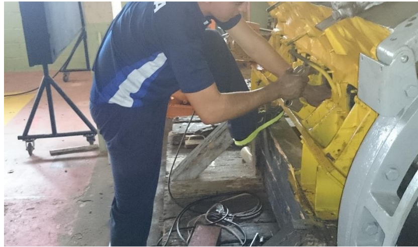
Figura 4.12. Extracción de sombretes Fuente: Laboratorio de Maquinaria Naval Elaborado por: El Autor
