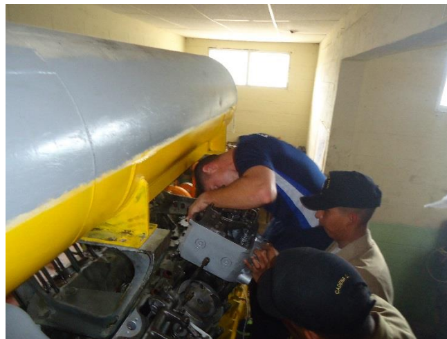
Figura 4.24. Montaje de Cabezotes Fuente: Laboratorio de Maquinaria Naval Elaborado por: El Autor
