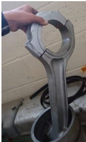
Figura 2.24. Biela del motor estudiado Fuente: Laboratorio de Maquinaria Naval Elaborado por: El Autor
