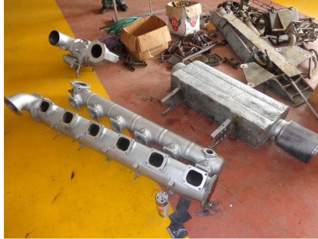
Figura 4.6. Múltiples y Enfriador de aire Fuente: Laboratorio de Maquinaria Naval Elaborado por: El Autor
