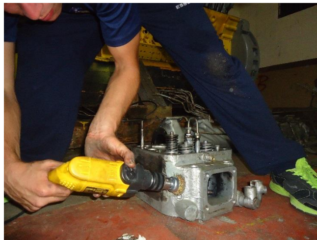
Figura 4.17. Cepillado del exterior de los cabezotes Fuente: Laboratorio de Maquinaria Naval Elaborado por: El Autor
