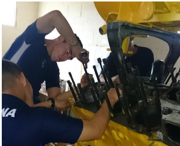
Figura 4.21. Montaje de Pistones Fuente: Laboratorio de Maquinaria Naval Elaborado por: El Autor
