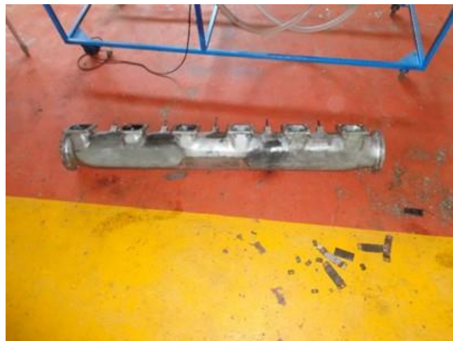
Figura 4.5. Múltiple de escape Fuente: Laboratorio de Maquinaria Naval Elaborado por: El Autor
