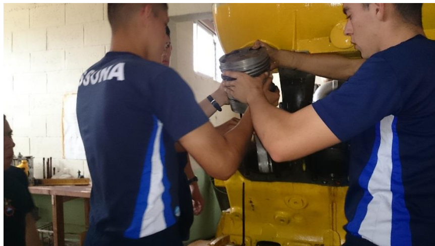
Figura 4.13. Desmontaje de Pistón Fuente: Laboratorio de Maquinaria Naval Elaborado por: El Autor
