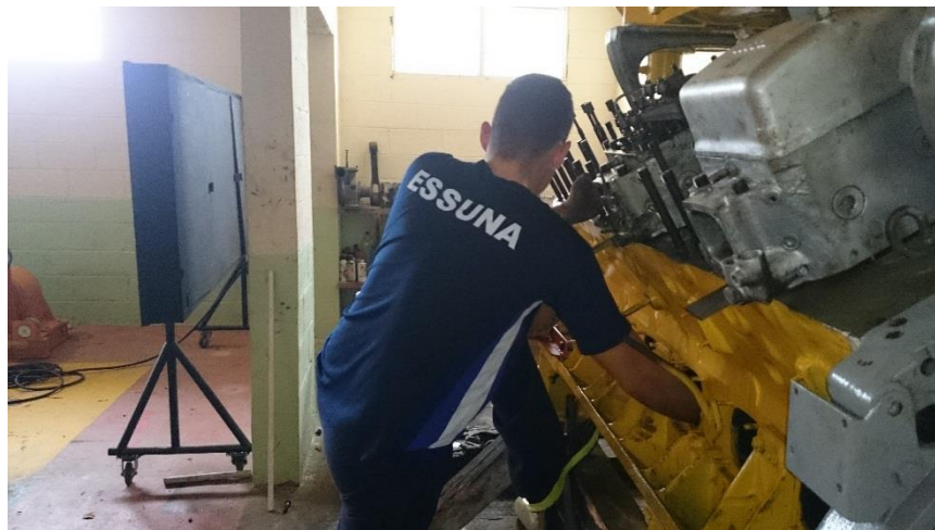
Figura 4.11. Verificación en el interior del bloque Fuente: Laboratorio de Maquinaria Naval Elaborado por: El Autor
