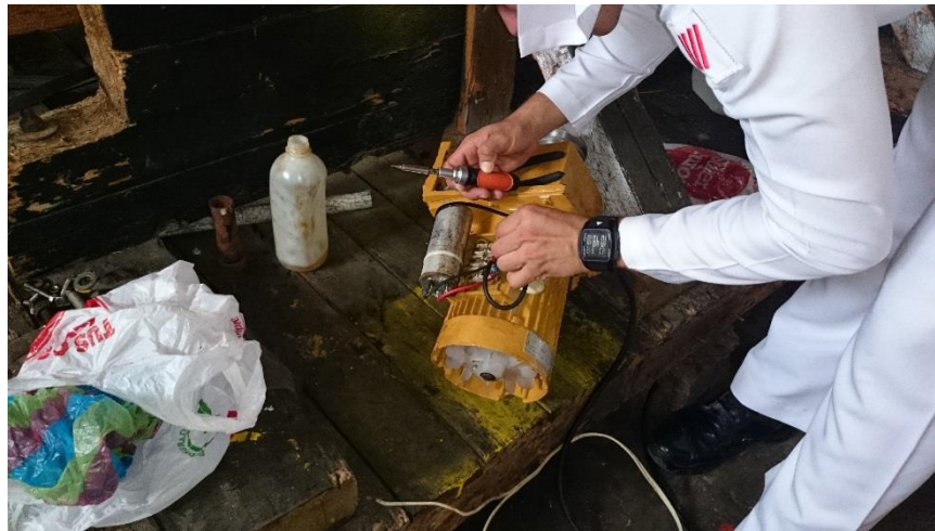
Figura 4.27. Adaptación de cable para conexión Fuente: Laboratorio de Maquinaria Naval Elaborado por: El Autor
