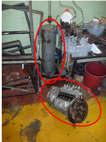
Figura 4.8. Bomba de combustible y enfriador de aceite Fuente: Laboratorio de Maquinaria Naval Elaborado por: El Autor
