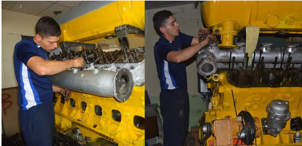
Figura 4.25. Montaje de múltiples de admisión Fuente: Laboratorio de Maquinaria Naval Elaborado por: El Autor
