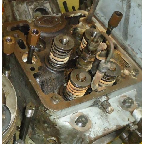
Figura 4.4. Cabezote corroído Fuente: Laboratorio de Maquinaria Naval Elaborado por: El Autor
