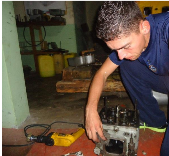
Figura 4.18. Limpieza de residuos en el cabezote Fuente: Laboratorio de Maquinaria Naval Elaborado por: El Autor
