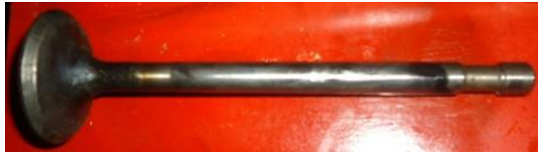
Figura 2.30. Válvula de admisión/escape Fuente: Laboratorio de Maquinaria Naval Elaborado por: El Autor
