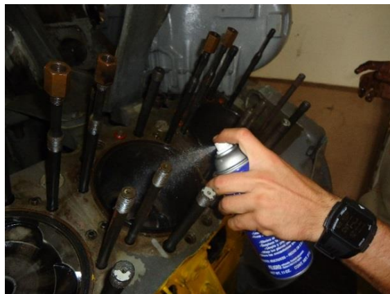
Figura 4.39. Aplicación de aceite lubricante Fuente: Laboratorio de Maquinaria Naval Elaborado por: El Autor
