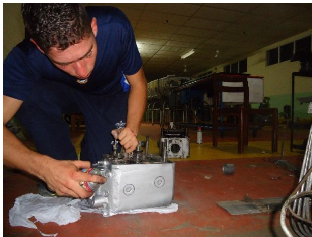
Figura 4.19. Pintada de cabezotes Fuente: Laboratorio de Maquinaria Naval Elaborado por: El Autor
