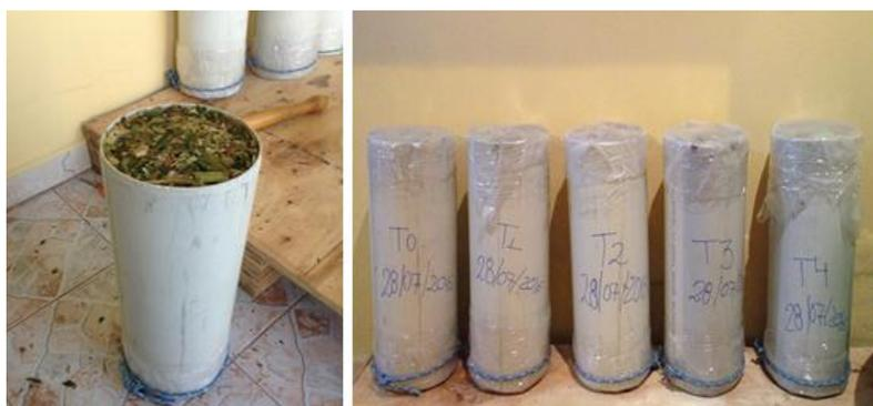
**Figura 5.** Simulación de proceso de ensilaje en tubo de PVC.
