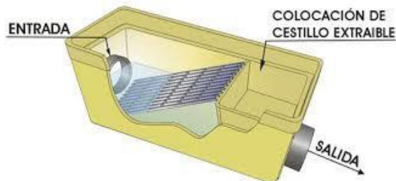
**Figura 2.1 Tratamiento de agua por el método de cribado**
