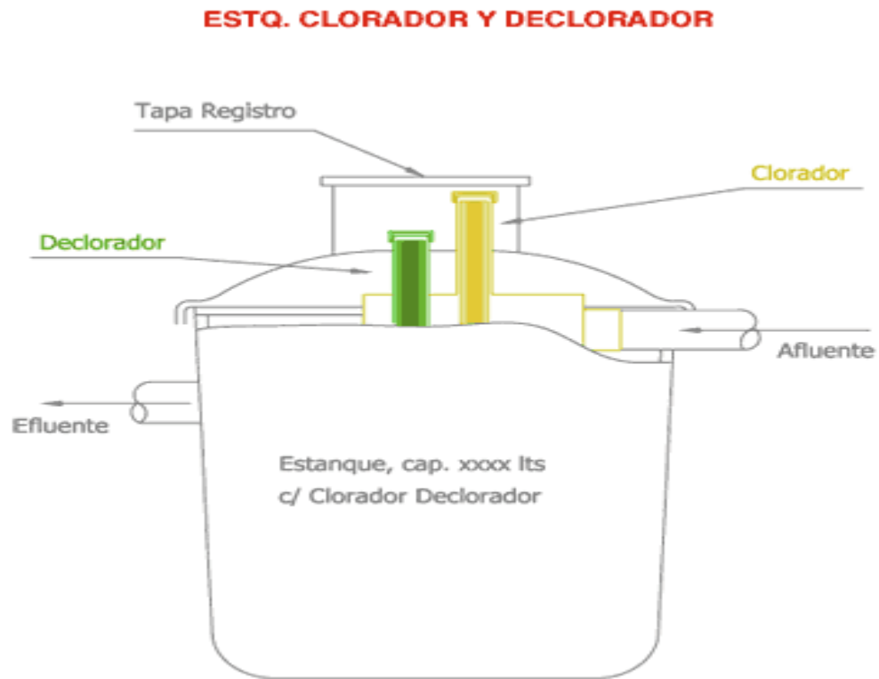
Figura 4.3 Estanque Clorador y Declorador. Fuente: Manual de Usuario Biodigestor. Elaborado por: Manual de Usuario Biodigestor.
