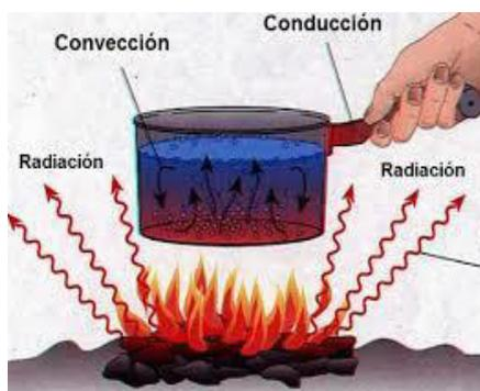
**Figura 2. Métodos de transmisión de calor**
