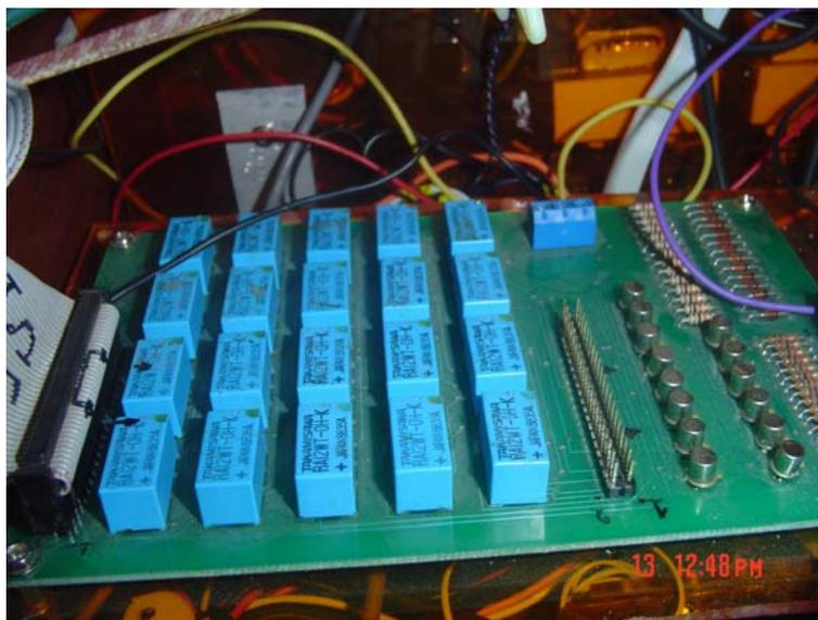
**Figura. 3.8. Circuito de la primera placa de relés**
