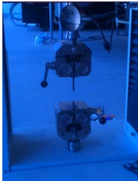
c) Ensayo finalizado con la probeta después de la falla
