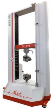
Figura 39 Máquina Universal de ensayos MTE – 50 Fuente: (Vicent Fombuena et al. , 2016)
