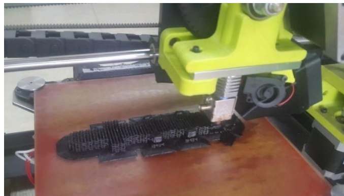
Figura 103 Impresión dedo medio: Órtesis de Mano
