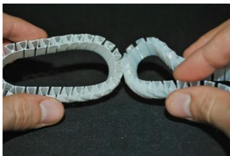
Figura 34 Impresión de una oruga en Soft PLA Fuente: (“Guía de plásticos”, 2014)
