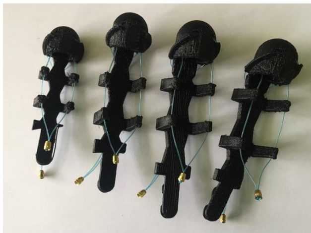
Figura 106 Dedos de la Órtesis de Mano con tensores
