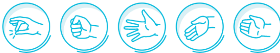
Figura 71 Gestos manuales detectados por sensores musculares EMG patentados Fuente: (Myo, 2016)
