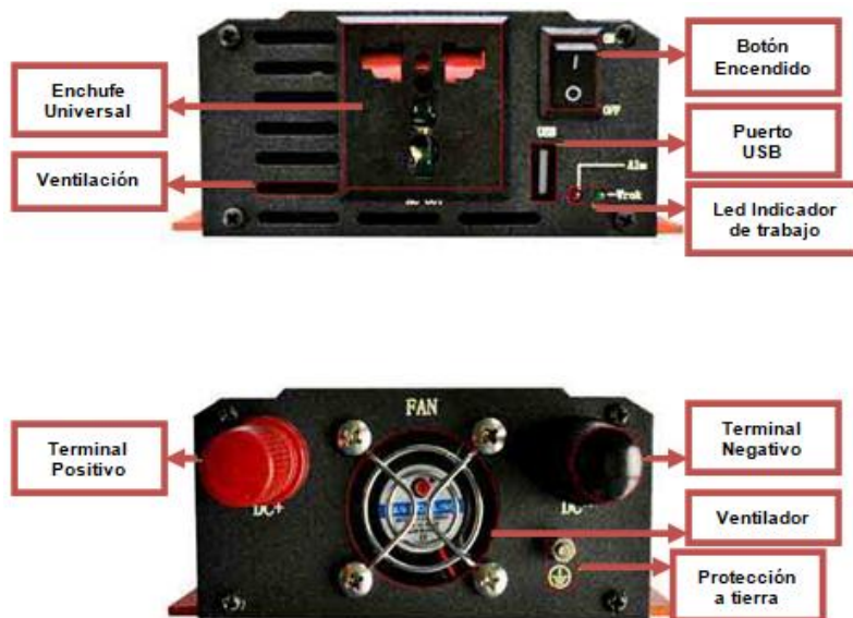
Figura 47. Partes del Inversor
