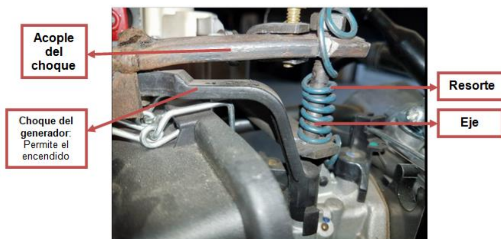
Figura 34. Elementos del mecanismo para arranque automático
