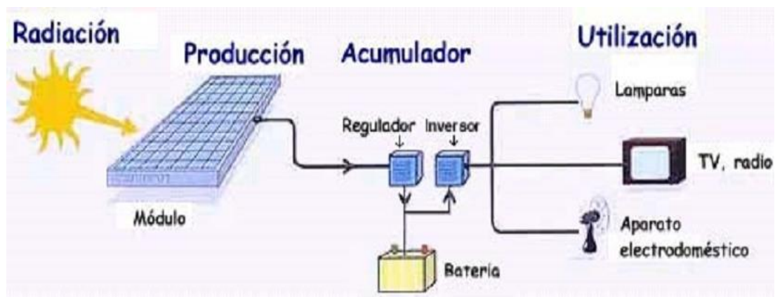
Figura 5. Elementos de la microgeneración fotovoltaica
