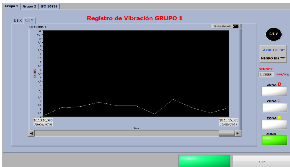
Figura 44. Registro de vibración, eje "Y" grupo 1.
