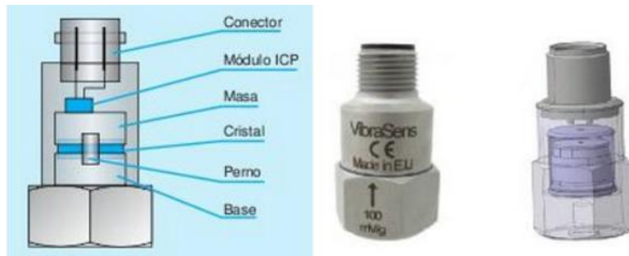
Figura 3. Transductor y acelerómetro piezoeléctrico
